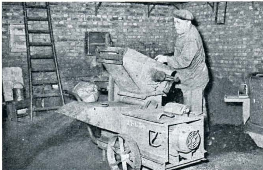
Het vormzand komt uit de meng-pletmachine en wordt in een machine geworpen om mechanisch te worden gezeefd.
