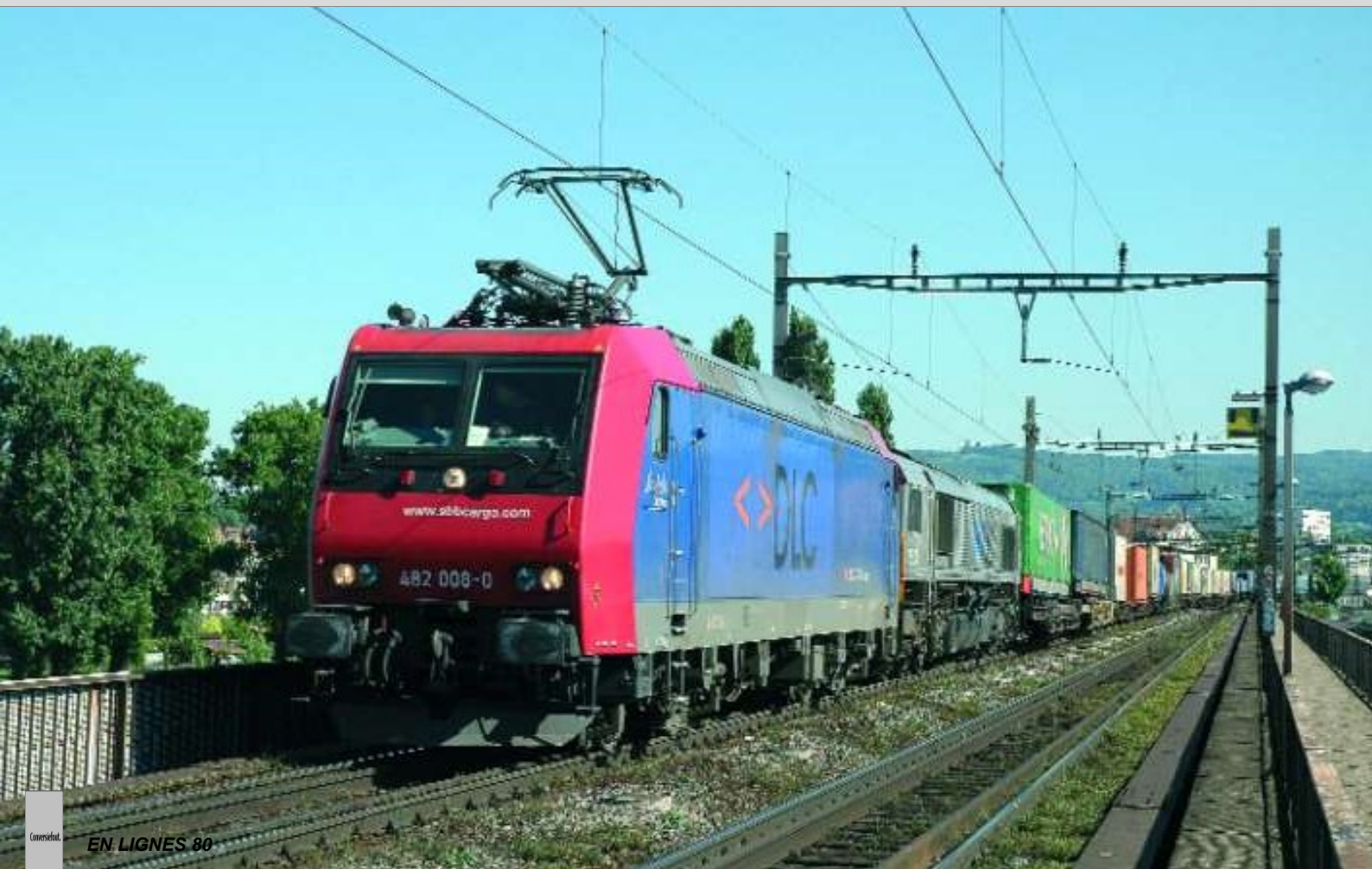
DLC 43672 Basel RB - Antwerpen rijdt op 19 mei 2007 over de Rijnbrug te Basel Breite. De trein wordt gesleept door twee DLC-locomotieven : TRAXX Re 482 008-0 en Class 66 DE 6301. Patrice AIROLDI.
