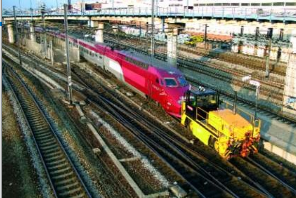
Sinds mei 2007 wordt het spoor/wegvoertuig gebruikt voor rangeringen met de HST-stellen in de werkplaats van Brussel-Zuid. Op 13 september verplaatst deze tractor het Thalysstel 4533 PBA ter hoogte van het station Vorst-Zuid.
