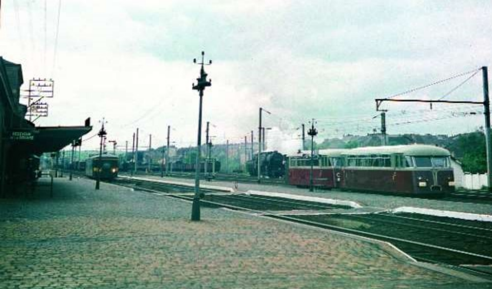
FOTO BD-269 In 1957 zien we in het station van Athus, rechts op spoor 3, een CFL-trein, samengesteld uit een dieselmotorwagen van de reeks Z 151 t/m 160 gekoppeld aan een bijwagen van de reeks RZ 1050 t/m 1061. Links op spoor 1 zien we een Brosse-motorwagen van het type 553 van de NMBS die wacht op het vertrek naar Virton. Achter de CFL-motorwagen zien we stoomloc 26.057 van de werkplaats Latour rangeren in de goederenbundel.
