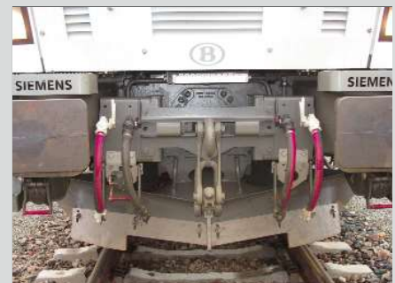
Een volgens de slijtage van de wielen regelbare baanruimer is bevestigd langs de beide uiteinden van het onderstel. Het doet tevens dienst als sneeuwruimer. Eric VAN HOECK.
