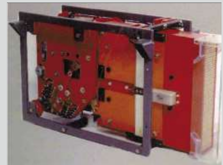
↑ De hoofdschakelaar voor gelijkspanning. Hij is opgesteld in de 3 kV hoogspanningskast.
