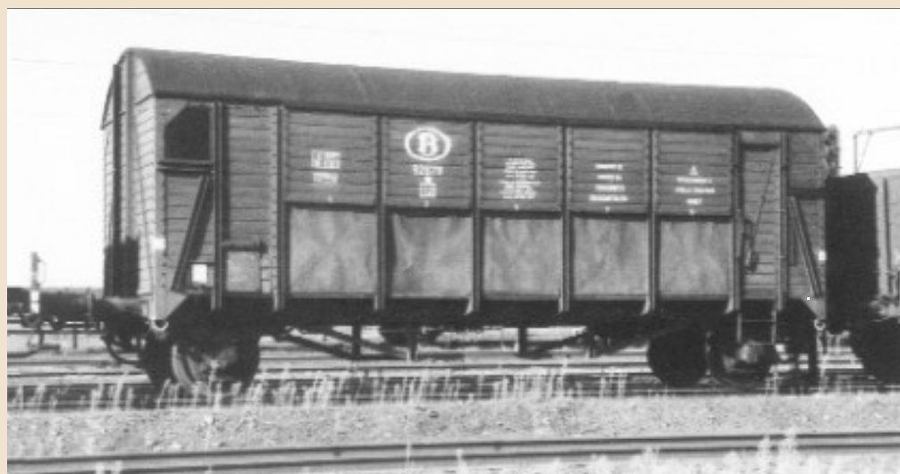
Dienstwagen 92.679 voor het vervoer van "draagmetalen". Deze dienstwagen was oorspronkelijk een pakwagen van het type Pwgs-43, door NMBS omgebouwd tot een wagen "Bremen" en later tot dienstwagen. De versterking, aangebracht aan het onderstel, is duidelijk zichtbaar. Verzameling Charles OCSINBERG.
