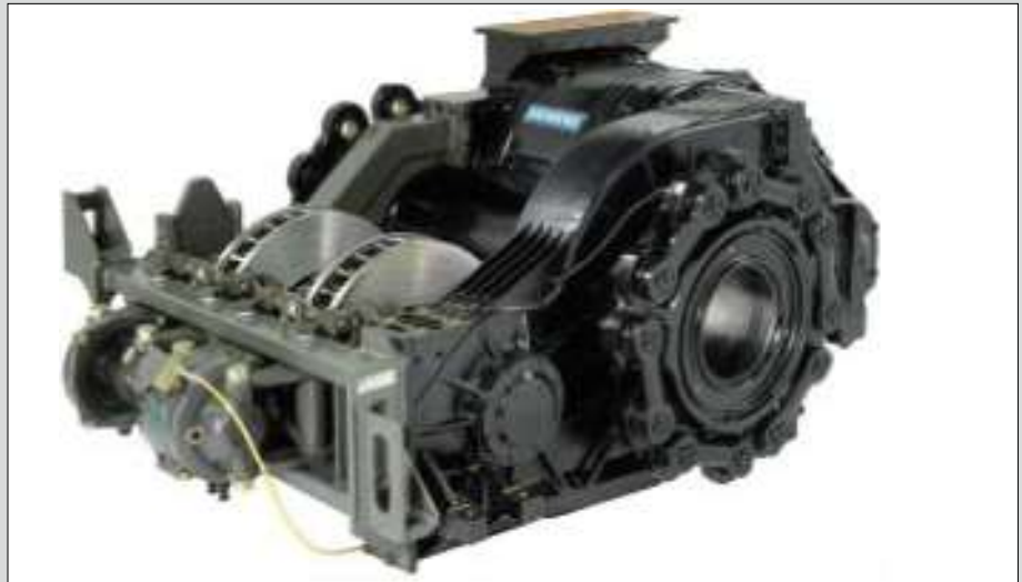
Doorsnede ↑ en foto ↓ van de transmissie en de remas.
