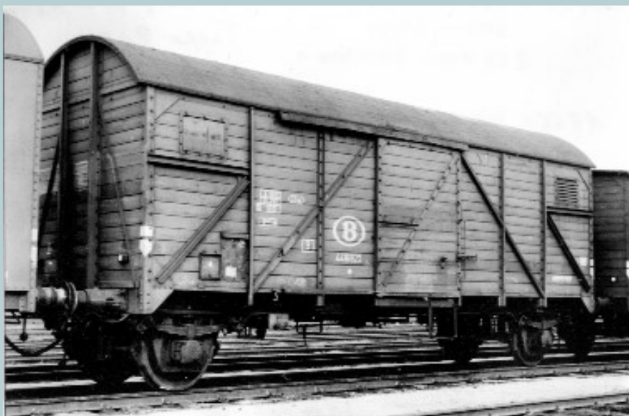
De NMBS-wagen 4.416.926 type 2021. Dit is een ex-pakwagen Pwgs-43 die werd omgebouwd tot een gesloten wagen type "Bremen". Verz. Charles OCSINBERG.
