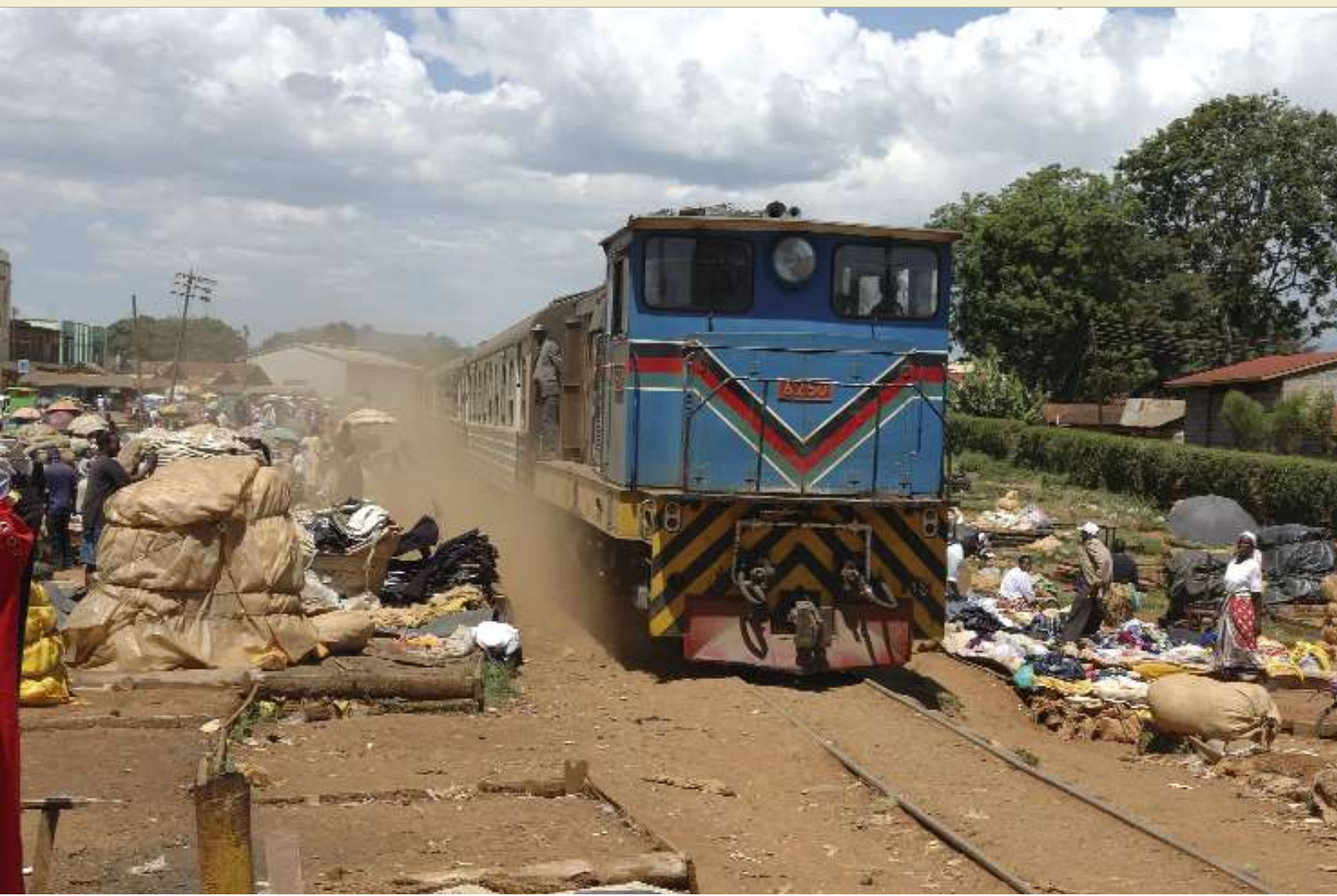
FOTO 91-54 Thyssen-Henschel leverde van 1977 tot 1979 een reeks van 56 locomotieven met hydraulische overbrenging. Hun asindeling was B'B' en zij hadden een vermogen van 550 kW. Op 4 januari 2009 komt een reizigerstrein, gesleept door de 6250, aan te Karatina. Thierry NICOLAS.
