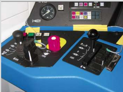
De remkranen van de automatische (rechts) en rechtstreekse rem (links).
