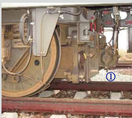
De remvoering omvatten twee schijven gemonteerd op een as parallel aan de wielas, verbonden met de holle as via de tandwielen. Deze foto toont de ① remcilinder.
