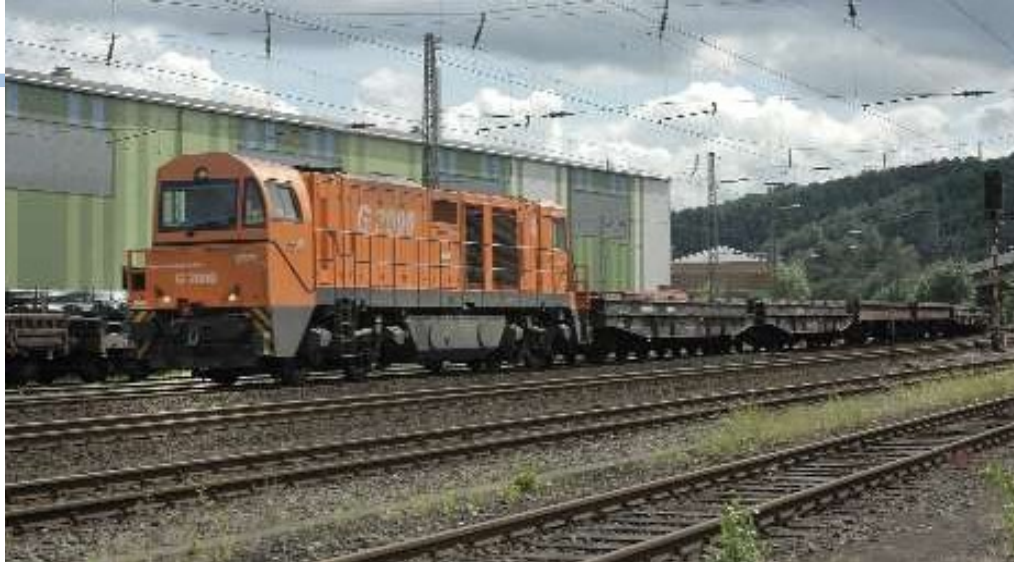
FOTO 93-48 De G2000 nr. 45 van de «Siegener Kreisbahn» te Hüttental-Geisweid. Deze locomotief behoort tot de eerste 20 exemplaren, die met asymmetrische stuurcabines zijn uitgerust. Pierre HERBIET.
