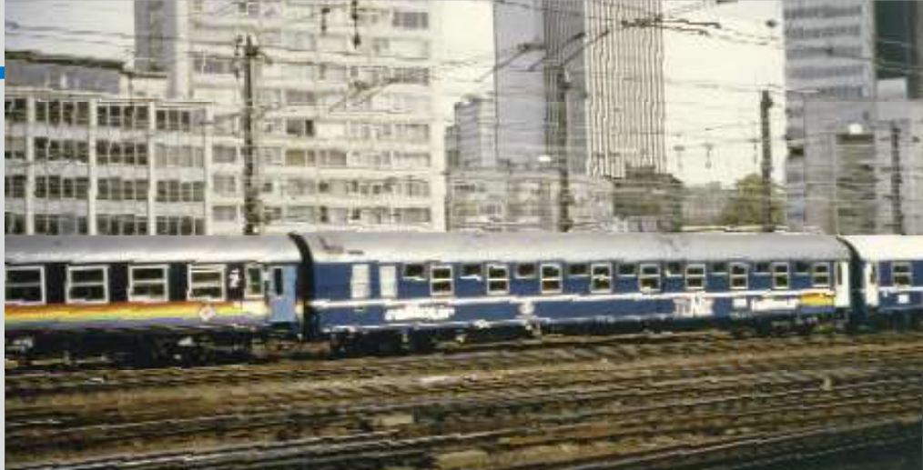
↑ Het rijtuig T2 nr. 5110 (UIC 71 88 75 70-156-8) in Railtour livrei, ingesloten in de "Freccia del Sole" bij doorrit te Brussel-Noord. De foto werd genomen langs de kant van de slaapcabines Daniel THIELEMANS.
