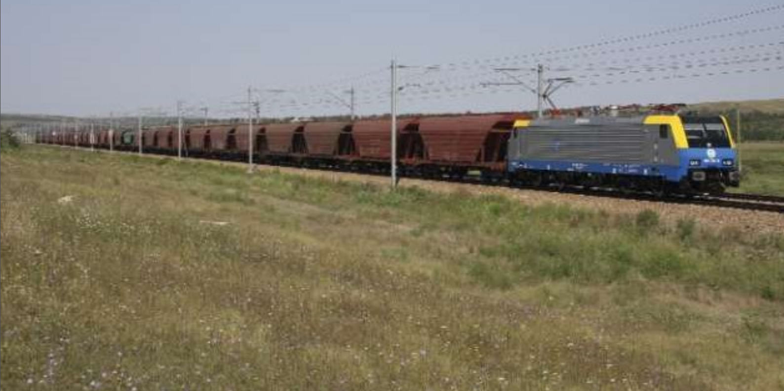
FOTO 94-66 De nieuwste bij de CFR in dienst zijnde locomotief is intussen ook alweer 25 jaar oud. Privéoperator CTV echter nam begin augustus 2009 twee krachtvoertuigen van het type Eurosprinter ES64F4 (189 700-8 en 189 701-6), gebouwd door Siemens, in dienst. Doorrit van de 189 700-8 met een graantrein aan de haak op 16 augustus 2009 te Mircea Voda. Philippe DE GIETER.
