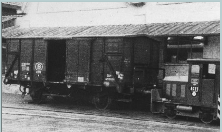
De NMBS-wagen 4.417.116 met afgebroken remmershuis (ex-NMBS 237.339) was een hybride wagon die tijdens het Interbellum werd geleverd. Deze van oorsprong Duitse wagens werden door de Belgische Staat genummerd in de reeks 257.000 tot 277.999 als type 2021. Voor hun inzet in de "EUROP"-pool kregen ze de nummers 295.001 tot 297.999 (later 3.317.000 tot 3.317.999 en 4.417.000 tot 4.417.999). Verzameling Charles OCSINBERG.
