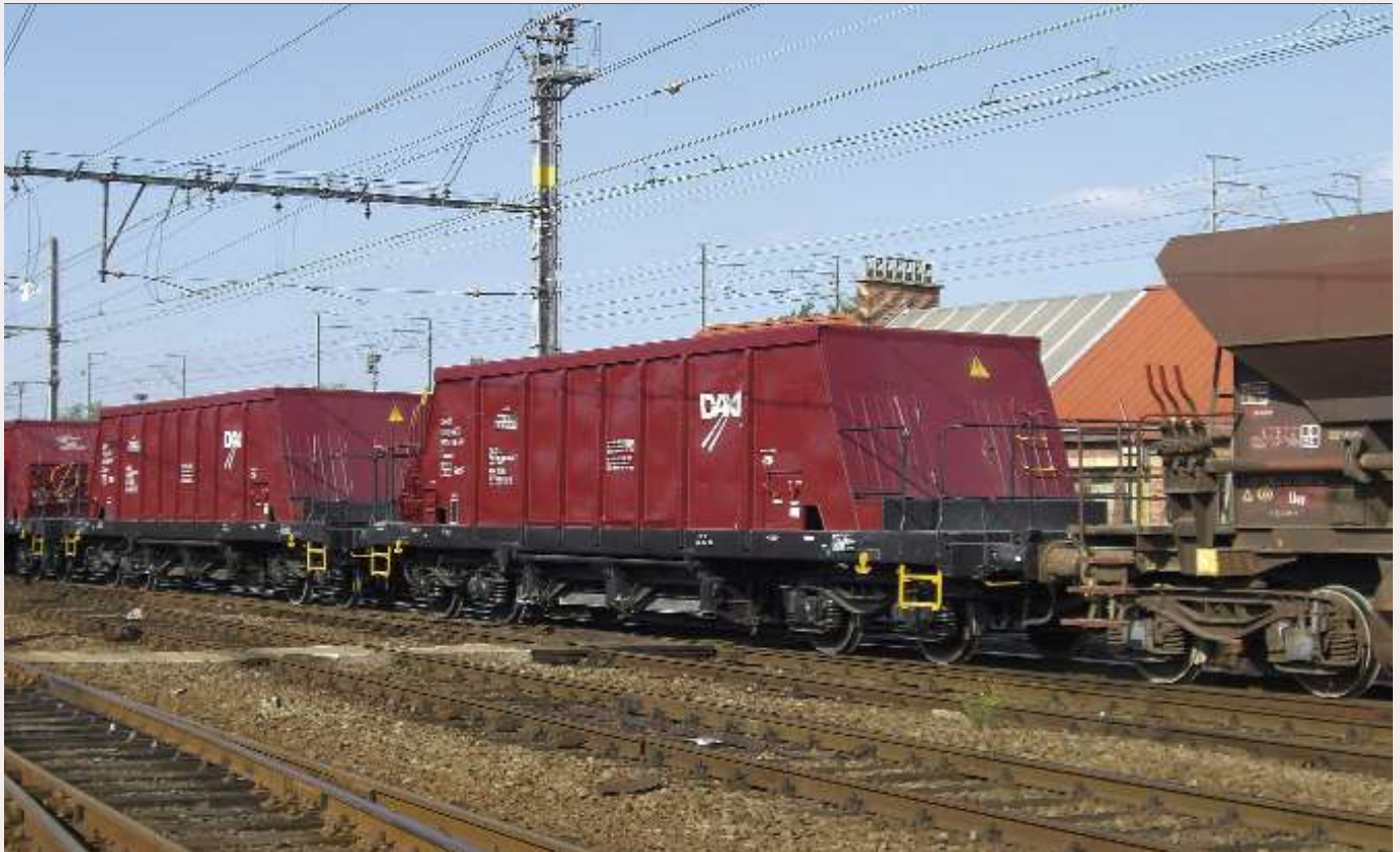
FOTO 94-34 De wagens voor het vervoer van ballast die worden gehuurd door Infrabel. De eerste draagt het UIC-nr. 33 53 RO -GFR 6993 796-6 P. Schaarbeek, 17 september 2009. Jean-Luc VANDERHAEGEN.
