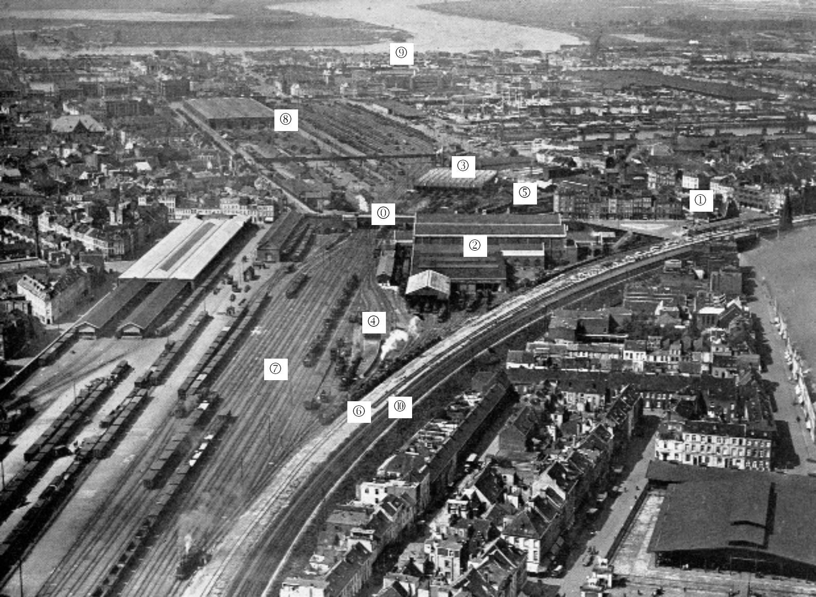
Een luchtfoto van de installaties van Antwerpen-Dam in de jaren '30. ① De brug (Viaduct dam) die het ganze complex overbrugt, ② Het stationsgebouw; ③ Werkplaats voor herstelling en onderhoud; ④ Locomotievenloods met achteraan het administratief gebouw; ⑤ Draaischijf en later tankinstallatie voor de bevoorrading met gasoil en zand; ⑥ Kolenbunker voor het bevoorraden van de stoomlocomotieven; ⑦ De nieuwe lijn 12 Antwerpen - Roosendaal in aanbouw; ⑧ Lijn 12A Antwerpen-Schijnpoot – Antwerpen-Dokken & Stapelplaatsen; ⑨ Stapelplaatsen en loodsen van de douane “Dokken en Stapelplaatsen”; ⑩ De oude haven en de Schelde; ⑪ De oude lijn 12 die later lijn 27A werd naar Antwerpen-Noord.
