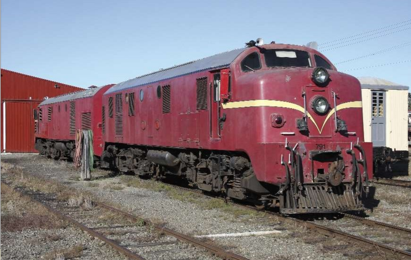
FOTO 95-61 De Weka Pass Railway in Waipara baat een lijn van 12km naar Waikari uit. Er worden twee van de vier bewaarde locomotieven van de reeks DG ingezet. In 1955 en 1956 werden 42 machines (A1A A1A) geleverd door English Electric, Vulcan Foundry en Robert Stephenson & Hawthorn. Ze verdwenen in 1983. Op 30 maart 2009 staan de 791 en 770 voor de stelplaats in Waipara. Philippe DE GIETER.
