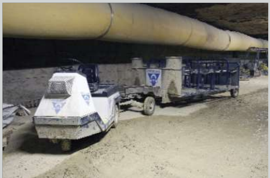
↑ Het personeel wordt vervoerd met "wagens" die door een elektrische tractor gesleept worden.
