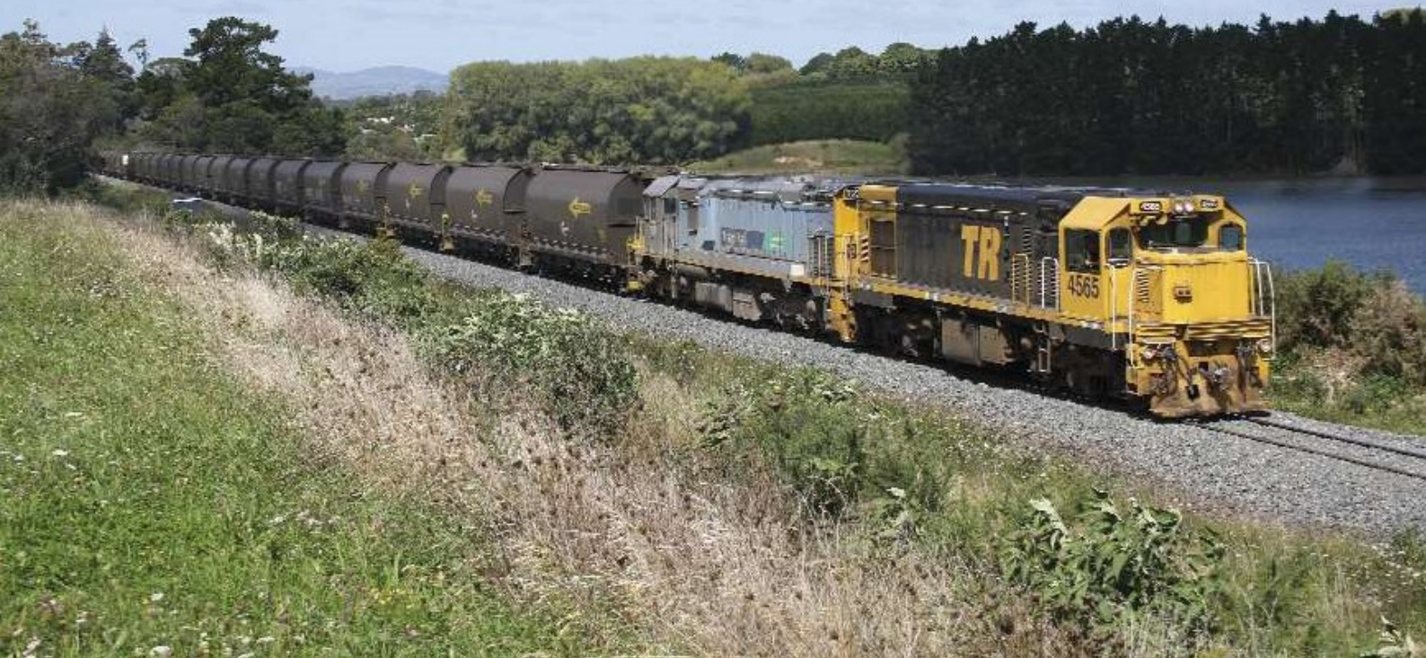
FOTO 95-57 Kiwi Rail werd op 1 juli 2008 opgericht naar aanleiding van de overname van Toll Rail door de overheid. Kiwi Rail baat een net van 3898 km uit, met een spoorbreedte van 1,067 m. Hiervan is ongeveer 500 km geëlektrificeerd. Op 20 maart 2009 slepen de DC4565 en DFT7239 een steenkooltrein nabij Omokoroa, op de lijn Mount-Maunganui - Hamilton. Philippe DE GIETER.
