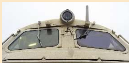
↑ Een zicht op de antenne van de afstandsbediening.
