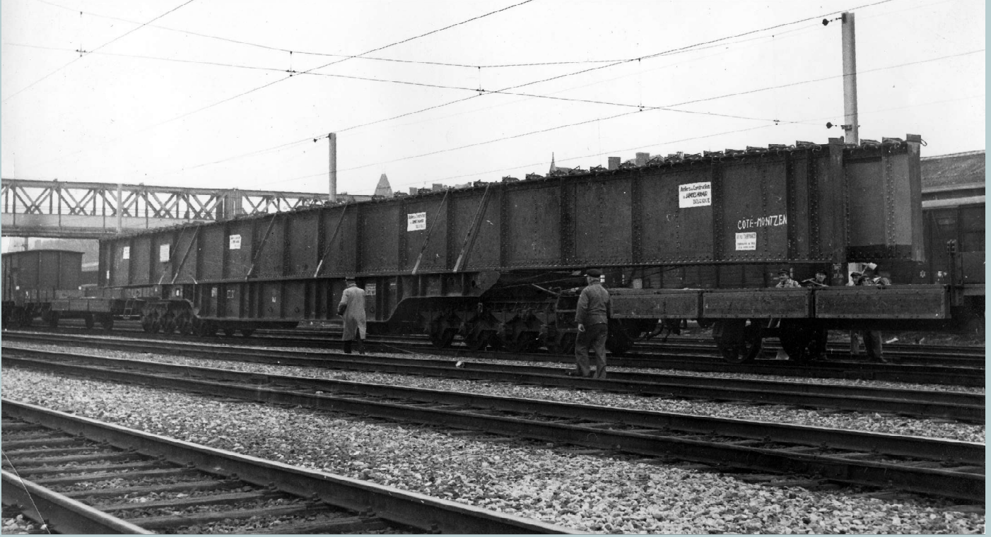
↑ De wagen in gebruik voor het vervoer van de brugdekken van de nieuwe brug van Bois-de-Breux (lijn 38 Chênée - Montzen). Deze hadden een gewicht van 40 ton en werden gebouwd door de Ateliers de Constructions de Jambes-Nord. De foto werd in het station van Namur gemaakt. De rebordessen werden verwijderd om deze lading te kunnen vervoeren. Verzameling TSP.
