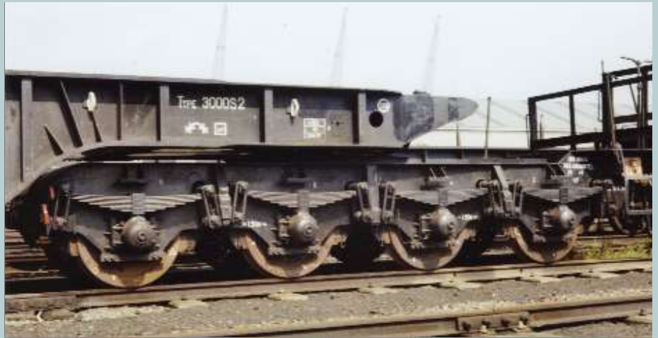
↑ De wagen in gebruik voor het vervoer van de brugdekken van de nieuwe brug van Bois-de-Breux (lijn 38 Chênée - Montzen). Deze hadden een gewicht van 40 ton en werden gebouwd door de Ateliers de Constructions de Jambes-Nord. De foto werd in het station van Namur gemaakt. De rebordessen werden verwijderd om deze lading te kunnen vervoeren. Verzameling TSP.
