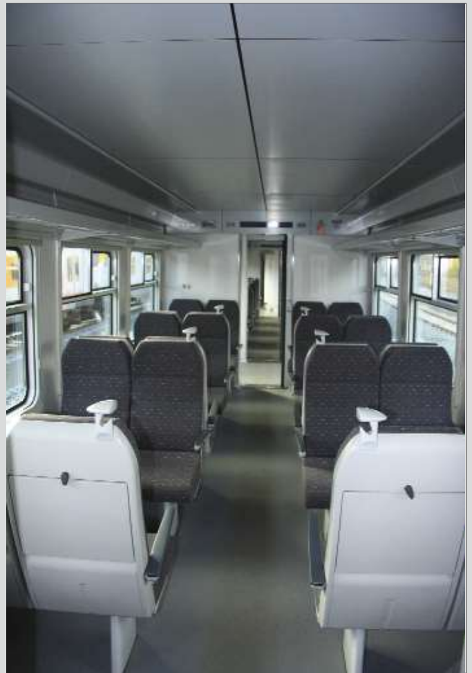
Het tussenrijtuig bestaat volledig uit tweede klasse-afdelingen. Alle oorspronkelijke zetels, die in een 2+2-opstelling staan, werden behouden en van een nieuwe bekleding voorzien.
