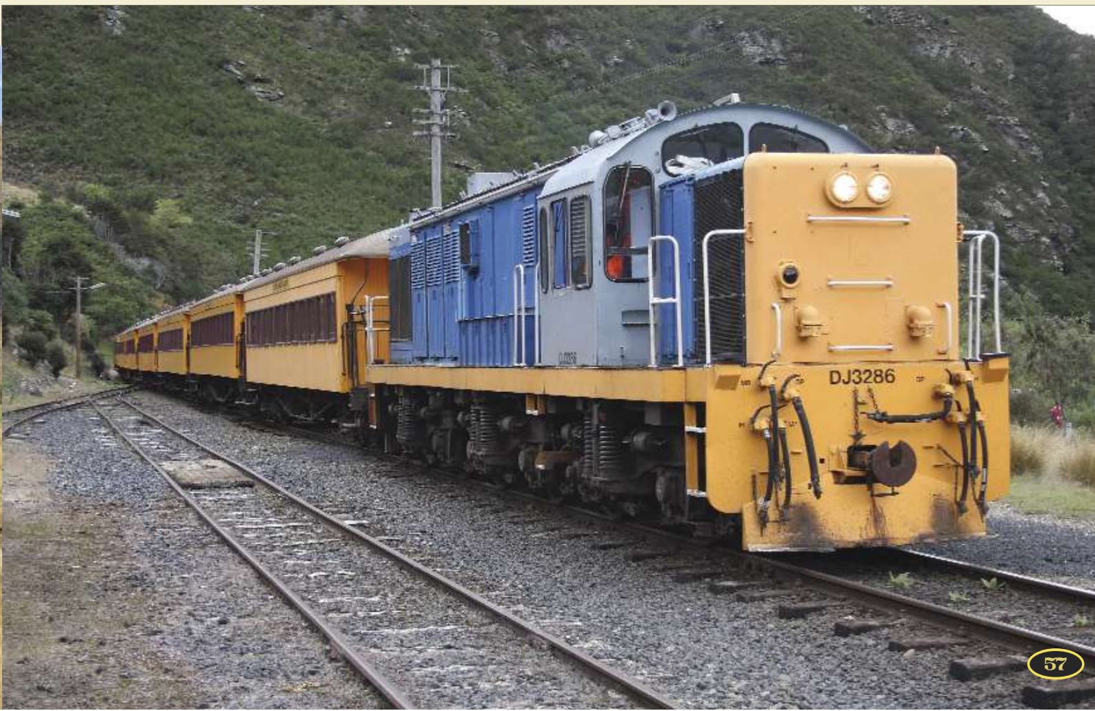
FOTO 95-62 Er bestaan ongeveer 60 verenigingen van spoorwegliefhebbers. Een van de belangrijkste is de TGR (Taieri Gorge Railway) die tussen Dunedin en Middlemarch (18km) rijdt. Er worden vijf diesel-elektrische locomotieven van de reeks DJ (Bo'Bo'Bo) ingezet. Ze werden in 1968 en 1969 door het Japanse Mitsubishi gebouwd. Bij de NZR werden ze tot 1989 gebruikt. Op 27 maart 2009 staat de DJ 3286 in Hindon met een trein naar Dunedin. Philippe DE GIETER.
