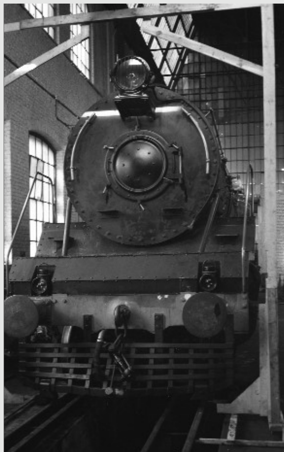
De constructie van de 1D1 type WG voor de Indische spoorwegen. Hierboven de WG-8502.
