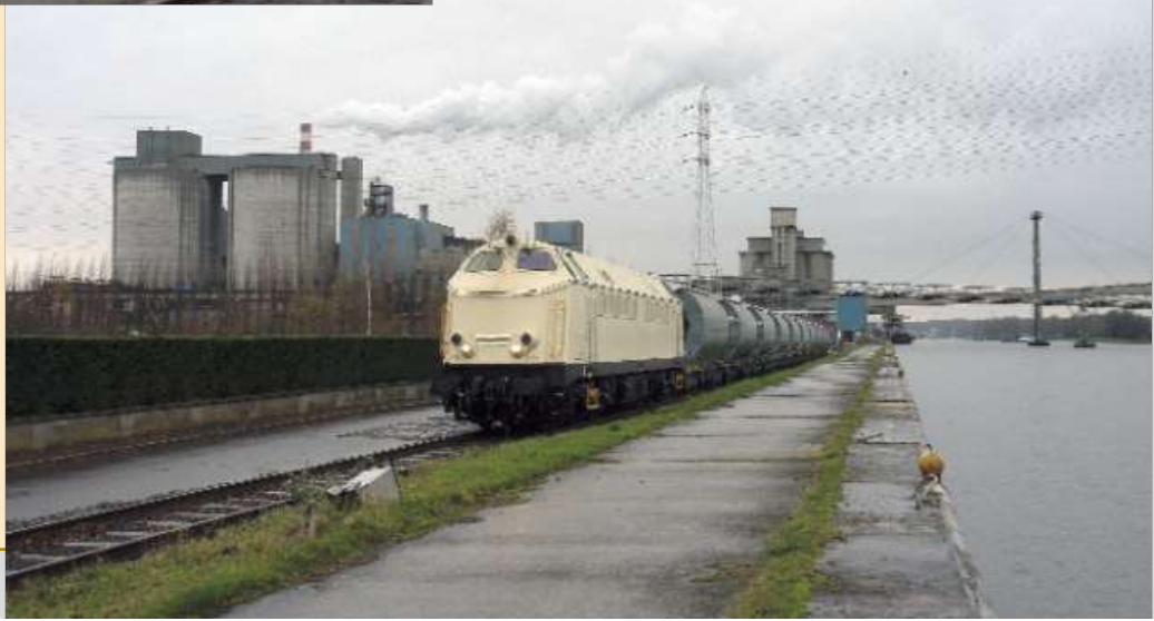
FOTO 95-04 → De 5172 duwt, zonder bestuurder aan boord, 11 wagens op naar de cementfabriek. De stuurpost met afstandsbediening bevindt zich nu steeds vooraan de trein. De machine wordt nooit achteraan gekoppeld. Pierre HERBIET.
