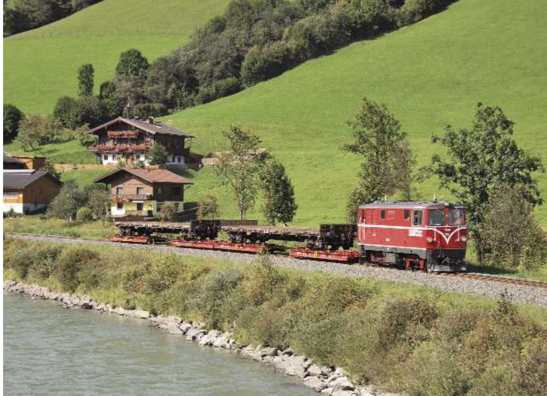
FOTO 95-53 De Vs73 (ex-ÖBB 2095 006) op de terugweg van Mittersill naar Zell am See met twee lege normaalsporige platte wagens, geladen op vier rolwagens. Jesdorf-Bergfried, 22 september 2009. Wim DE RIDDER.
