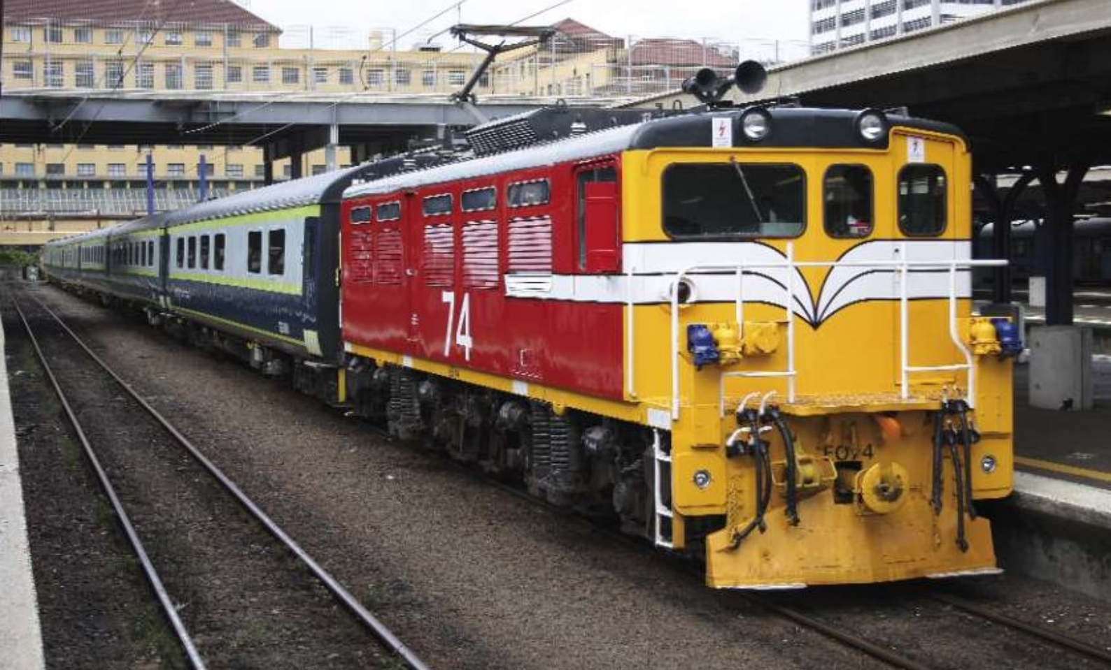
FOTO 95-59 In 1968 werden vijf elektrische locomotieven (Bo'Bo'-reeks EA, later EO) in dienst gesteld voor het opduwen van zware goederentreinen door de tunnel van Otira. Deze tunnel is 8500m lang en heeft hellingen tot 3%. De lijn door de tunnel werd geëlektrificeerd met 1500V gelijkspanning. Na de privatisering vond men het onderhoud van deze installaties echter te duur en in 1997 werd de bovenleiding afgebroken en de reeks EO werd buiten dienst gesteld. Omdat de tunnel weinig geschikt was voor het gebruik van diesellocomotieven leidde deze beslissing al snel tot zware problemen - maar het was al te laat... Sinds 8 december 2008 zijn drie locomotieven weer in dienst bij Kiwi Rail. Ze worden ingezet in de voorstadsdienst van Wellington waar het aantal reizigers sterk was gestegen. Op 1 april 2009 staat de EO74 met een stel Mark2-rijtuigen in het station van Wellington. Philippe DE GIETER.
