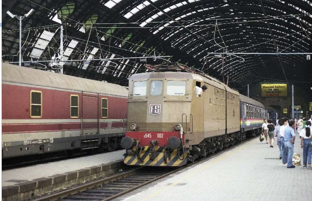
FOTO 95-45 Op 30 juni 1990 wordt de E645.002 (ex- E646.022, ex- E646.202 – OM/CGE 10-1959) aan kop van de "Freccia del Sole" Ancona – Brussel-Zuid gekoppeld in het station van Milano Centrale. De kast van de eerste 42 locomotieven E645/646 leek sterk op deze van de E636, met kopwanden die in drie vlakken verdeeld waren. De E645.002 werd geschrapt te Verona op 30 juni 2004. Jean-Luc VANDERHAEGEN.
