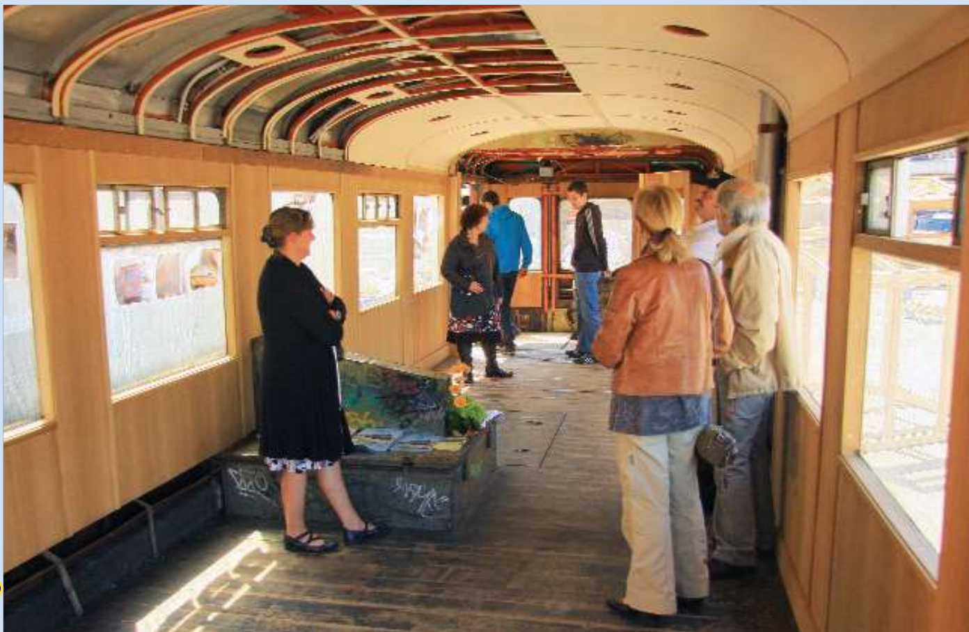
29 mei was er een opendeurdag in de technische school TIO te Overpelt. De ouders hadden de gelegenheid om het werk van studenten aan de 551.26 te bewonderen. De werken aan de binnenwanden en het plafond zijn goed gevorderd. Na de zomervakantie wordt in september de restauratie hervat. Foto's TSP / Freddy DELARBRE.
