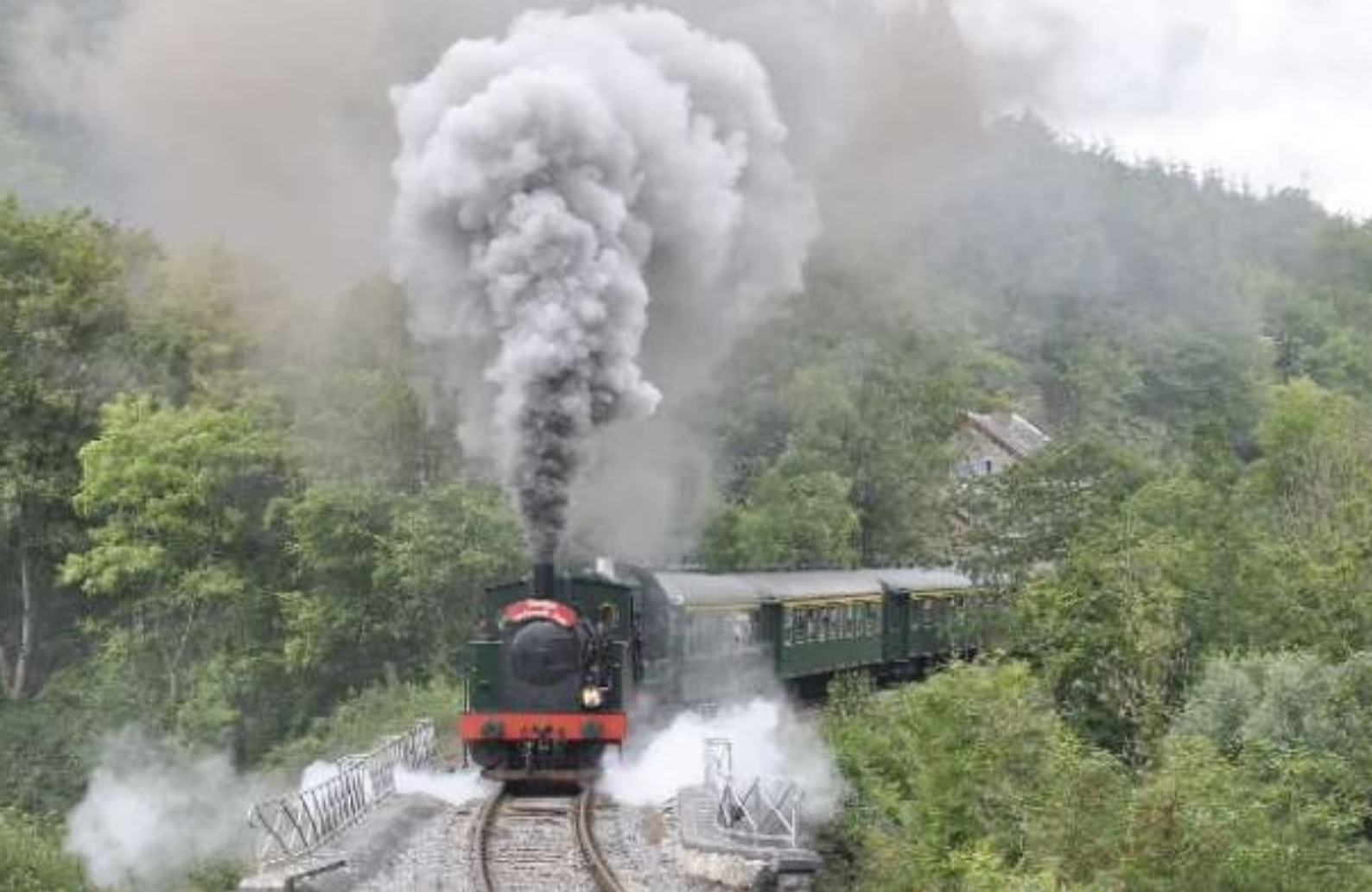
FOTO 105-14 Vertrek op volle kracht te Purnode. De Tubize 2069 van SDP wordt bijgestaan door de 270.005. Achteraan duwt de 806 CFL (niet zichtbaar op deze foto). Door de zware en bochtige helling van 16 ‰, was deze noodzakelijk om het vertrek van de trein mogelijke maken. Een echt spektakel! TSP / Geert MAES.
