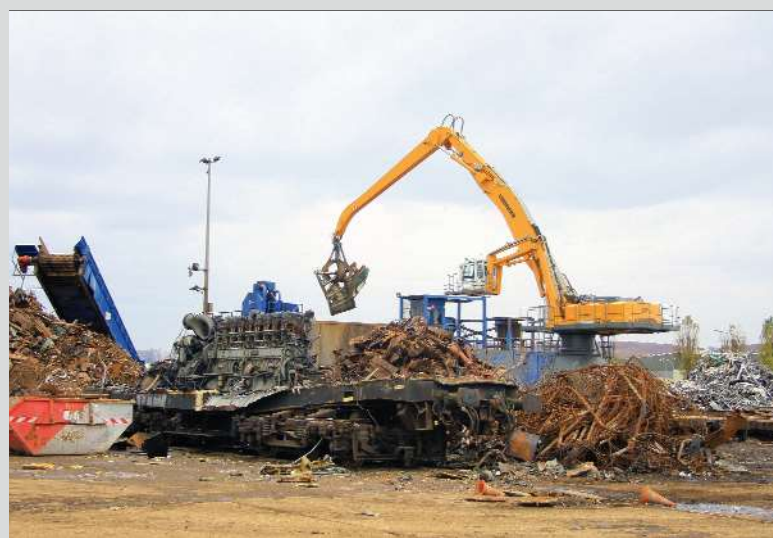
FOTO 108-17 ↓ - FOTO 108-18 ↘ Bij elke greep scheurt deze klauw nieuwe stukken uit de 5162...
