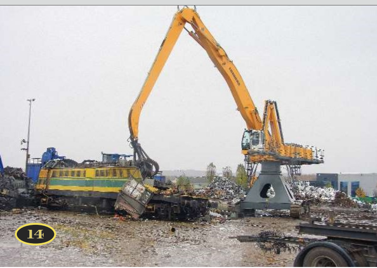
FOTO 108-17 ↓ - FOTO 108-18 ↘ Bij elke greep scheurt deze klauw nieuwe stukken uit de 5162...
