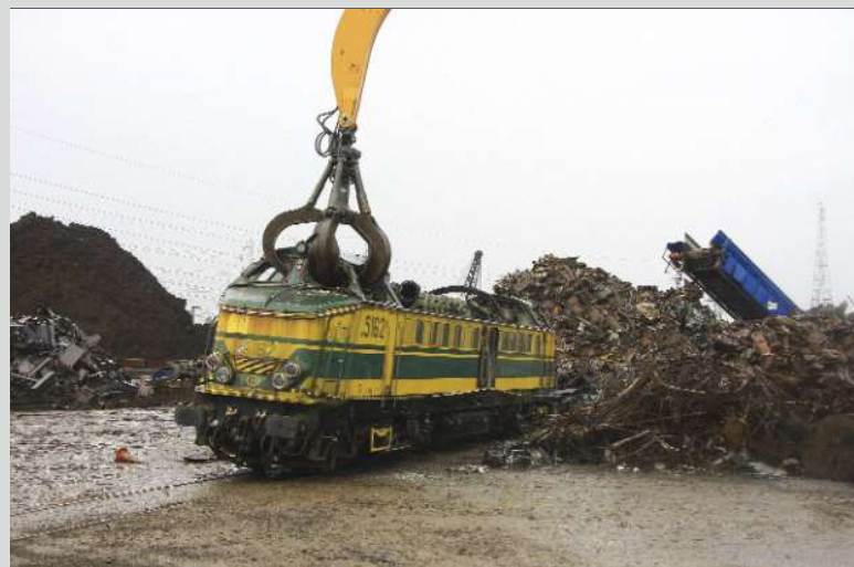
FOTO 108-15 ↑ - FOTO 108-16 ↗ De grijper heeft slechts enkele seconden nodig om de stuurpost af te rukken.
