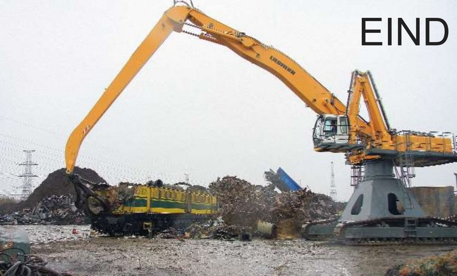
FOTO 108-14 ↑ De volgende foto's kunnen gevoelige spoorwegzielen kwetsen. Als dat in uw geval zo is, raden wij u aan om zo vlug mogelijk door te bladeren naar pagina 18... De sloopwerf LUXFER te Aubange is één van de belangrijkste werven die locomotieven van de NMBS verschroot. Onlangs is er een splinternieuwe kraan, met een hefvermogen van 30 ton, op rupsbanden in dienst genomen. Deze indrukwekkende machine heeft slechts enkele minuten nodig om van een robuuste locomotief een hoopje schroot te maken. Op deze pagina zien we de laatste minuten van de 5162. Aubange, 8 november 2011. Foto's: Pierre HERBIET.
