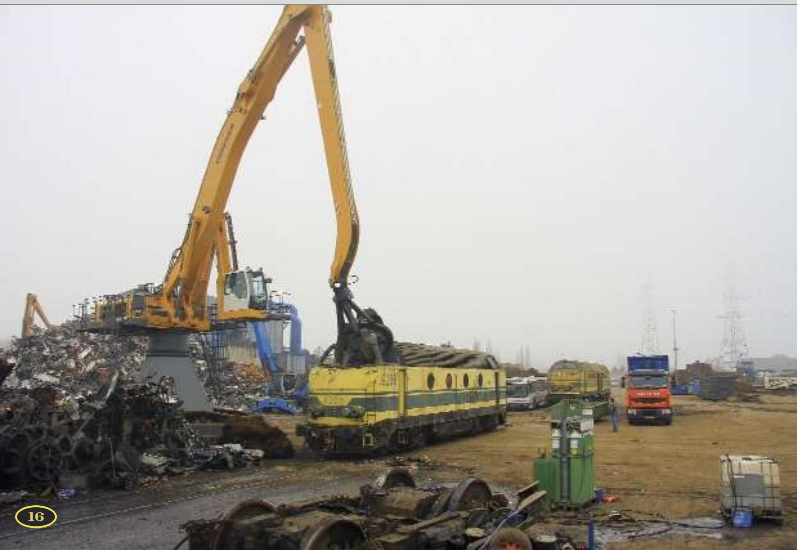
FOTO 108-24 ↑ - FOTO 108-25 ↓ Op 11 november 2011 is het de beurt aan de 6298 en de 5125 om verschroot te worden. Elk brok van de locomotieven zal dan naar de metaalverbrijzelaar gaan (linksachter zichtbaar) en eruit komen als metaalsnippers. Deze verbrijzelaar kan een halve wagen, overlangs doorgesneden, versnipperen in één maal. Foto's Pierre HERBIET.
