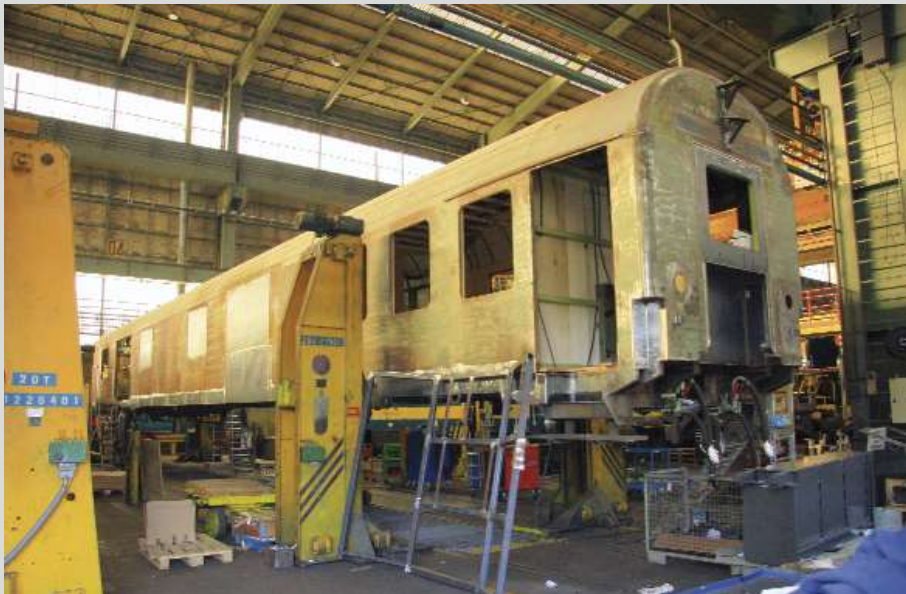
De carrosseriewerken met het opheffen van de intercirculatie, het dichtwerken van de oude toegangen van de pakwagen en het openwerken voor het aanbrengen van de nieuwe deuren die leiden naar het technische compartiment.
