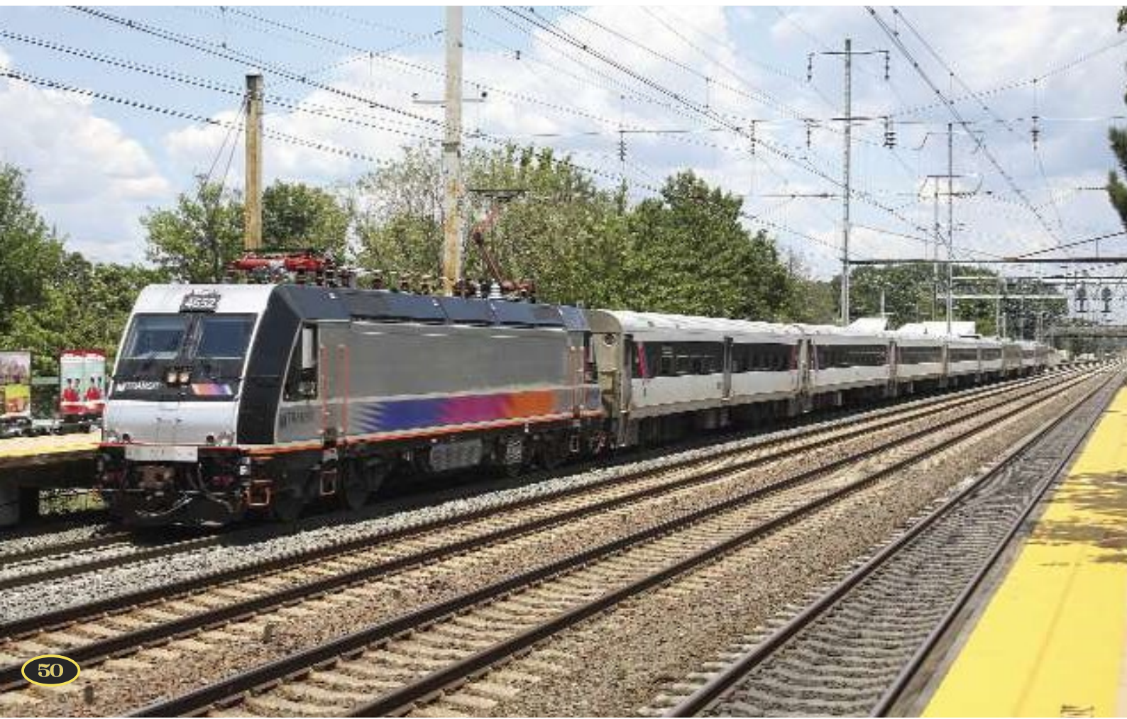
FOTO 108-89 Doorrit van de 4652 door het station Princeton Junction, New Jersey op 15 juli 2011. De 4652 werd gebouwd door Bombardier, is van het type ALP-46 en is gebaseerd op de BR 101 van de DB. Philippe DE GIETER.
