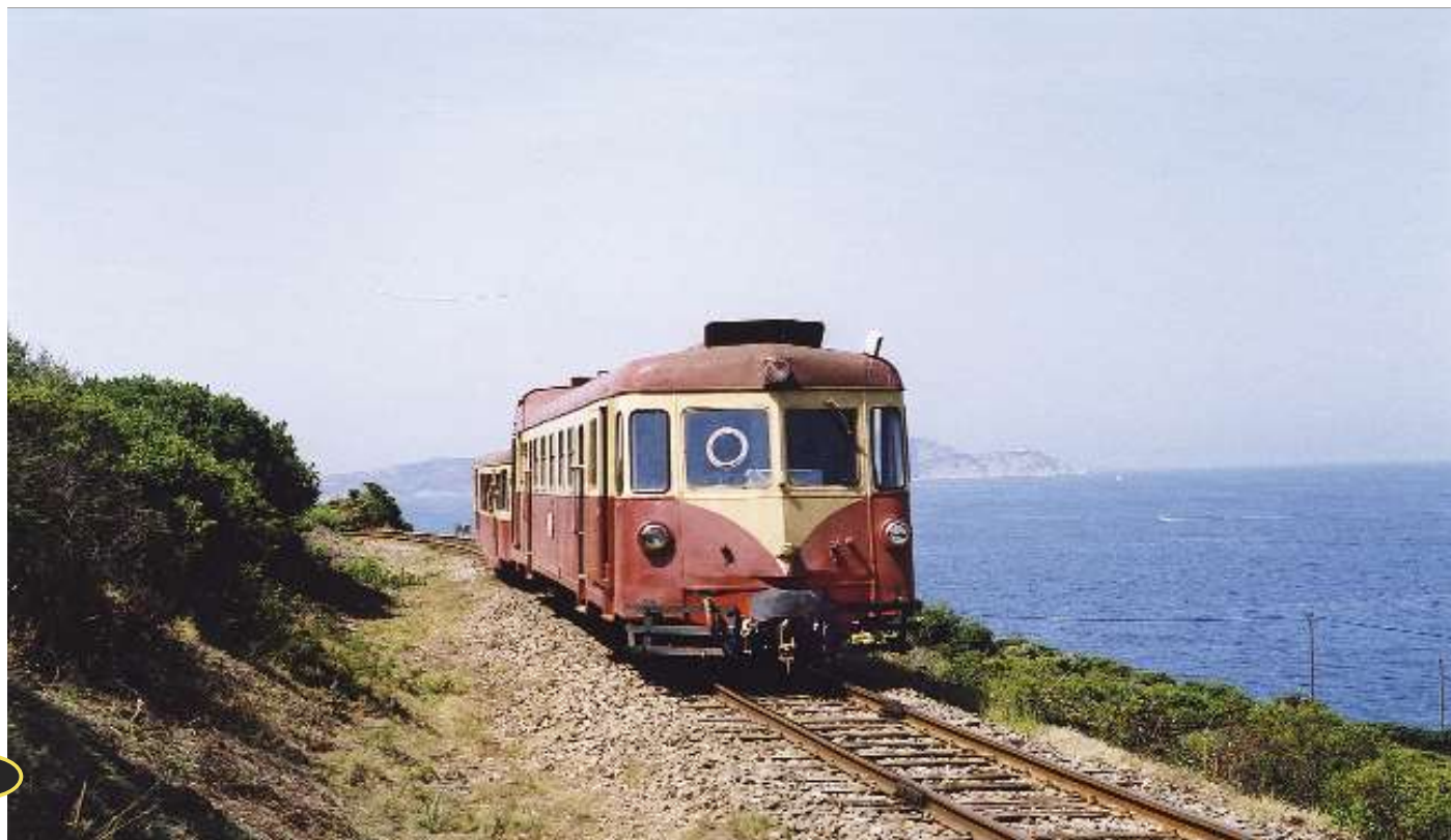
FOTO 108-86 De X204 met bijwagen XR113 rijden als trein 60 Calvi - Ile-Rousse langs Ondari-Arinella aan de baai van Calvi op 10 augustus 2004. De XR113 is een Billard-motorwagen gebouwd in 1938. In 1986 werd de motor verwijderd en werd het omgebouwd tot stuurstandrijtuig. Philippe DE GIETER.
