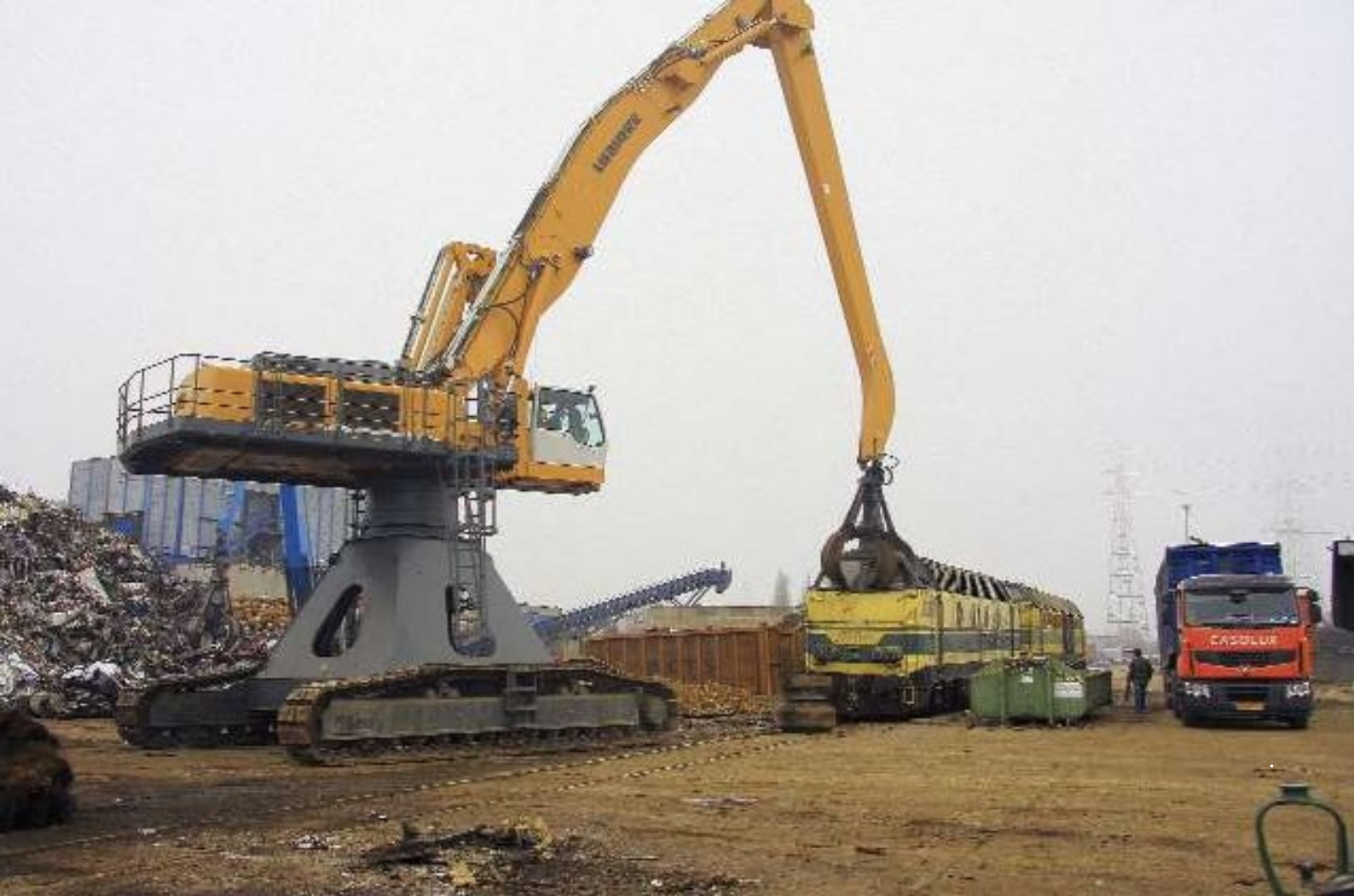
FOTO 108-24 ↑ - FOTO 108-25 ↓ Op 11 november 2011 is het de beurt aan de 6298 en de 5125 om verschroot te worden. Elk brok van de locomotieven zal dan naar de metaalverbrijzelaar gaan (linksachter zichtbaar) en eruit komen als metaalsnippers. Deze verbrijzelaar kan een halve wagen, overlangs doorgesneden, versnipperen in één maal. Foto's Pierre HERBIET.
