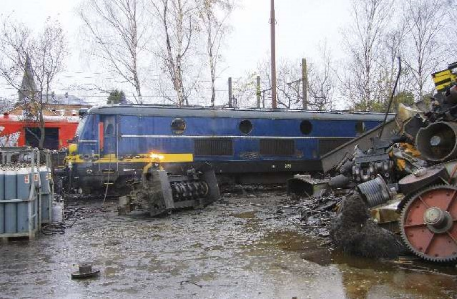
FOTO 108-26 ↑ Een andere verscroter, een andere verschrootmethode. Bij Keyser te Courcelles, ook een grote schrootwerf voor locomotieven, gebruikt men de traditionele brander. De executie duurt hier meerdere dagen... Op 13 december 2011 is het de beurt aan de 2553. Zij laat zich de buikwand opensnijden door een brander, in actie binnenin de locomotiefkast. Pierre HERBIET.
