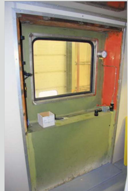
De carrosseriewerken met het opheffen van de intercirculatie, het dichtwerken van de oude toegangen van de pakwagen en het openwerken voor het aanbrengen van de nieuwe deuren die leiden naar het technische compartiment.
