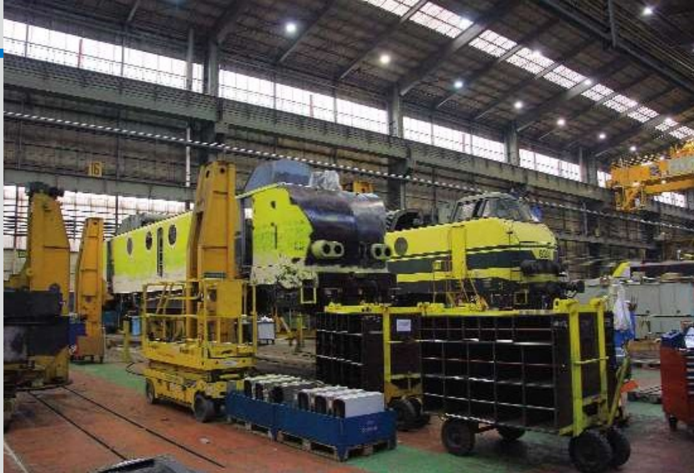
FOTO 113-12 De 6253 ondergaat momenteel een grote revisie in de CW Salzannes. Ze zal de werkplaats verlaten in hetzelfde blauwe kleedje al de 6255. Naast de 6253 de 6242 voor de installatie van de TBL1+. Yves COLIGNON, 2 oktober 2012.
