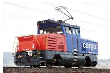
De nieuwe hybride locomotief Eem 923 001 (constructeur Stadler, aantal 30, snelheid 100 km/h, 1500 kW, dieselmotor 290 kW, spanning 15 en 25 kV). SBB.
