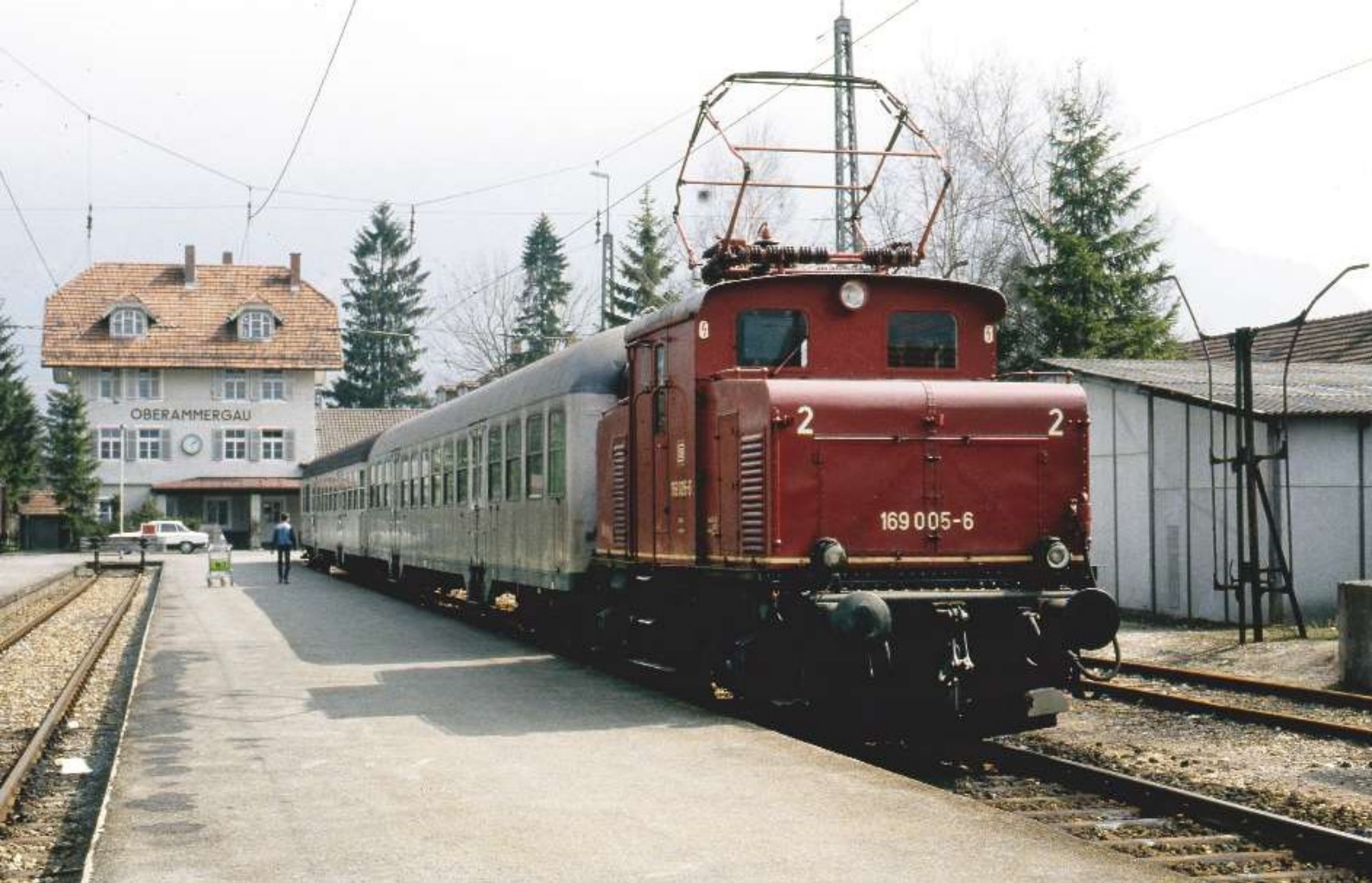
FOTO 113-67 ↑ De 169 005 staat in het station van Oberammergau klaar voor het vertrek. De motorkappen van deze locomotief waren veel groter dan die van de vier oudere machines. Ze woog 32 t terwijl het gewicht van de andere locomotieven varieerde van 23 tot 26 ton. Pierre HERBIET.
