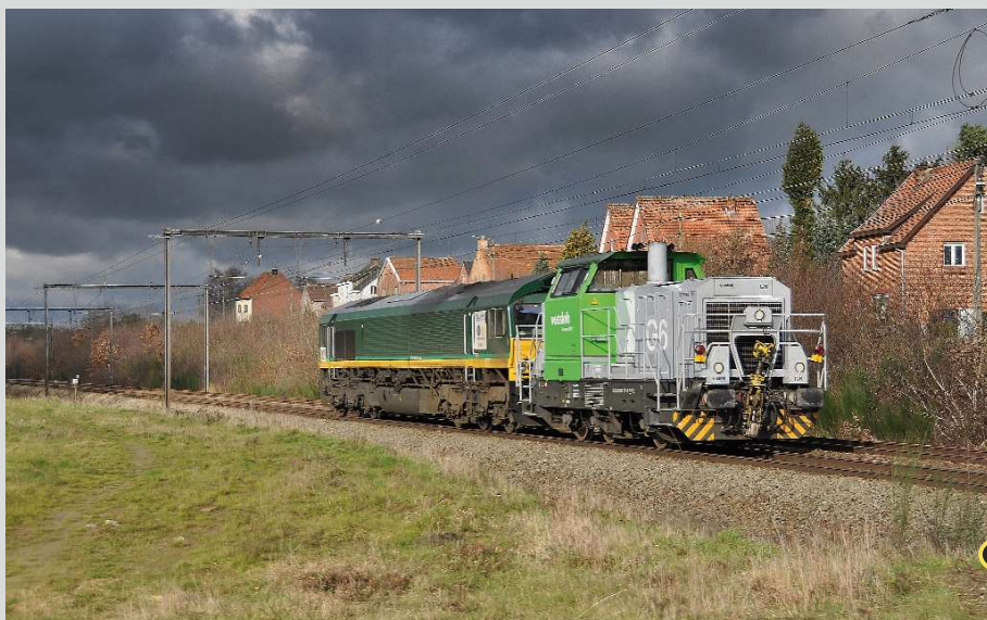
FOTO 114-60 BASF te Antwerpen ontving op 5 februari 2013 een nieuwe rangeerlocomotief. Het werd een machine van het type G6 van Vossloh, met constructienummer 5001862 / 2010 en het EVN-nummer 98 80 0650 104-9 D - VL. Als "Manfred" begon zij haar loopbaan op 6 oktober 2010 bij BASF te Ludwigshafen, vanwaar zij nu werd overgebracht naar de afdeling te Antwerpen. De machines type G6 zijn uitgerust met een Cummings dieselmotor QSK23 van 670 kW met hydraulische transmissie. Hun totale massa bedraagt 67,5 ton. Zij kunnen aan 30, 60 of 80 km/h rijden. De eerste G6-locomotieven verschenen in 2009. Doorrit van de G6 te Linkhout (tussen Hasselt en Diest), gesleept door de V267 van Rurtalbahn van Aachen West tot Antwerpen. Johny BRAUNS.
