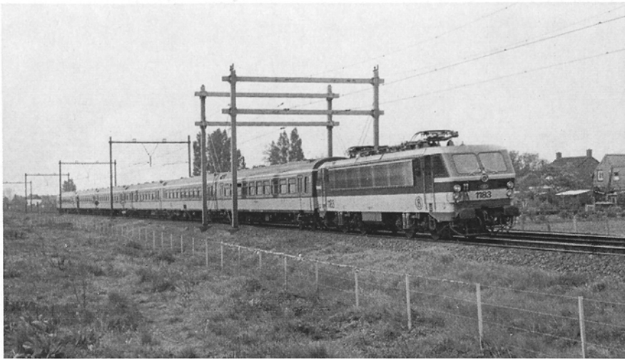
Lok 1183 met Beneluxstel aan de bovenleidingsluis te Rozendaal. Het draadloze gedeelte, dat van NMBS- naar NS-spanning (en omgekeerd) voert, dient met neergelaten stroomafnemers te worden gepasseerd. Foto Thierry Heylen, 10 mei 1987.
