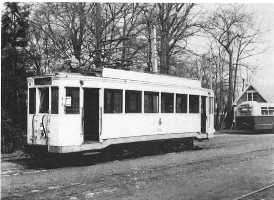
De 9635 als manoeuvreertuig in dienst in de stelplaats Oostmalle, omstreeks 1956-1957. De bissels en de derde as zijn vervangen door draaistellen. (Foto Fr. Keutgens)
