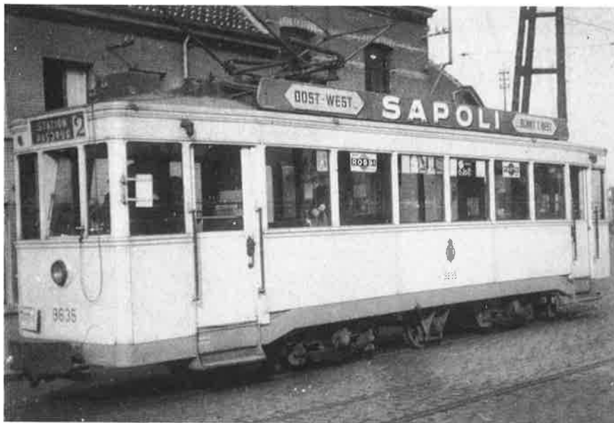
Mechelen, 1949. De 9635 in dienst op lijn 2, Station - Pasbrug. Eindpunt Pasbrug. De twee bissels Kamp en een derde as zijn duidelijk zichtbaar. Het koetswerk is klaarblijkelijk geïnspireerd op de Standaardrijtuigen. (Foto J. Clessens)
