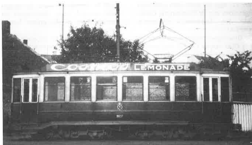
Merksem - Oude Bareel, omstreeks 1930-1931. De 9637 (ex-2) in het groen-crème geschilderd, met koersborden. Op het dak zijn een pantograaf en een trolleyestang geplaatst. (Fotograaf onbekend)
