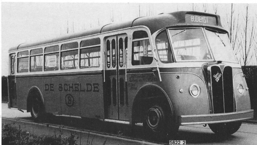
De tweede A.E.C., aangekocht door „Autobus De Schelde”, in 1949 door Carrosserie Jonckheere gebouwd op een Regal Mark III onderstel. Foto Archief Carrosserie Jonckheere.
