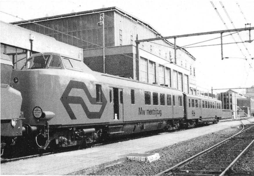
Van de Benelux stuurstandrijtuigen overleeft slechts rijtuig ex-107, nu verbouwd tot meetrijtuig Materieel en Werkplaatsen (Mw), bestemd voor het testen van de nieuwe lokreeks 6400 evenals voor de toekomstige elok-reeks 1700. Hoofdwerkplaats Tilburg, 5 mei 1988. Foto Bert Ossevoort.
