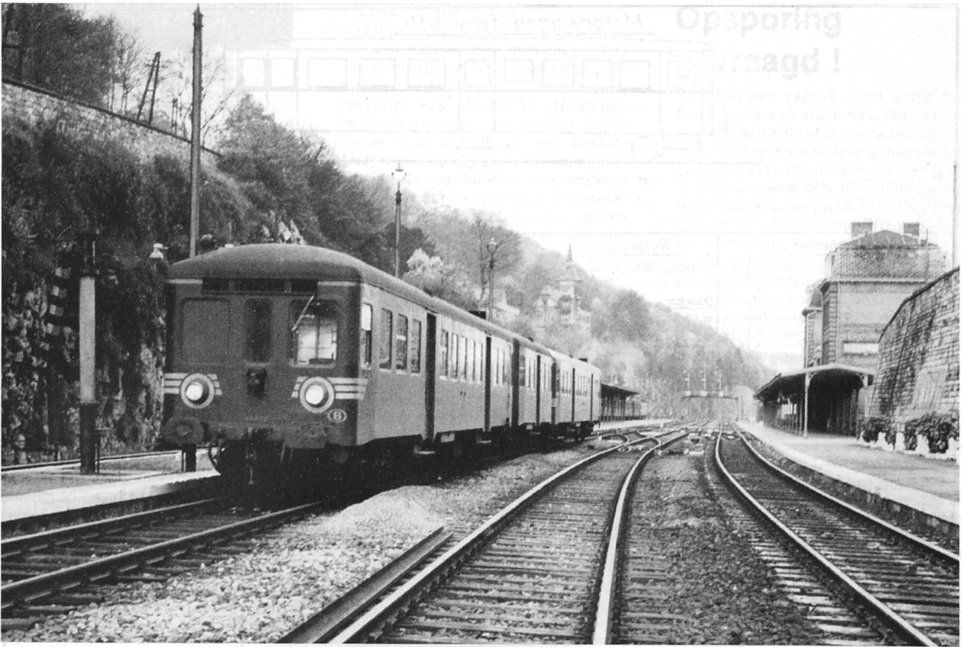
Station Dinant in augustus 1967 : motorrijtuig 603.22, samen met een andere 603 en een tussenrijtuig van het type 732. Van dit beeld blijven heden slechts het kasteeltje midden op de foto en rechts de gemetste stenen muur over : het stationsgebouw met de perronoverkapping, de seinbrug geheel achteraan, de waterkolom links, de karakteristieke lichtmasten en het rollend materieel zijn in de „nevelen des tijds” verdwenen... Foto Roger Belot, verzameling Ronald Mardaga.
