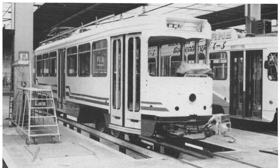
MIVA, Centrale Werkplaats Hoboken, 12 mei 1990. Tijdens een VeBOV-bezoek konden de deelnemers kennis maken met het omgebouwde prototype PCC 2100. Een betere toegankelijkheid, een vernieuwd vandalisme- en graffiti-vrij interieur en voornamelijk de toepassing van nieuwe elektronica moeten aan de 105 om te bouwen PCC's een nieuwe loopbaan geven van minimum 15 tot 20 jaar en aan de reizigers een aanzienlijk verbeterd reiscomfort. Foto Eric Keutgens.
