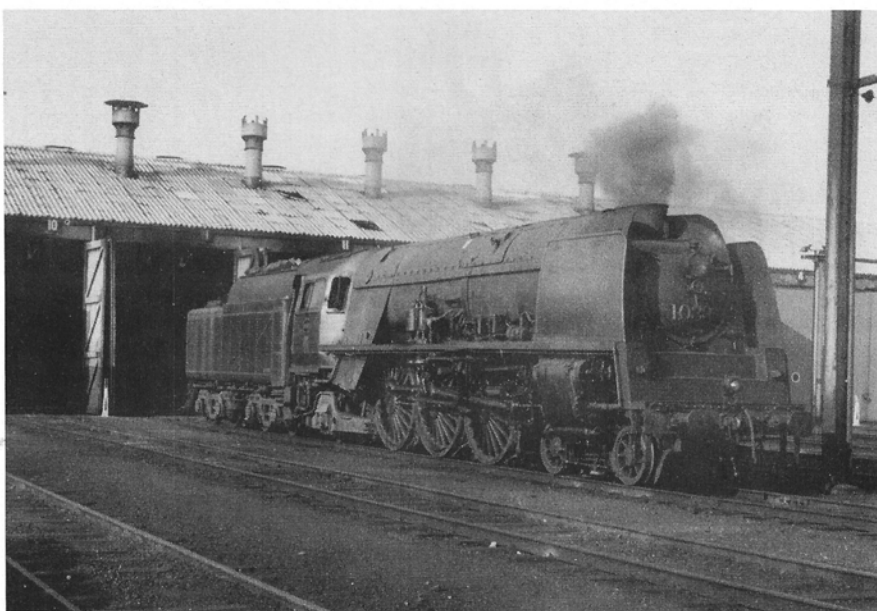
Loc 1.033 in het depot van Brussel Zuid. Let op de bijzondere stroomlijn vorm van de machine, de kleppen in de stroomlijnmantel (met het oog op de toegankelijkheid van de toestellen op de ketel), de dubbele (rem-)luchtpomp op de rechtervoetplaat, de Kylchap-uitlaat, de Amerikaanse bissel, de tender met de van rolagers voorziene monobloc-draaistellen...
