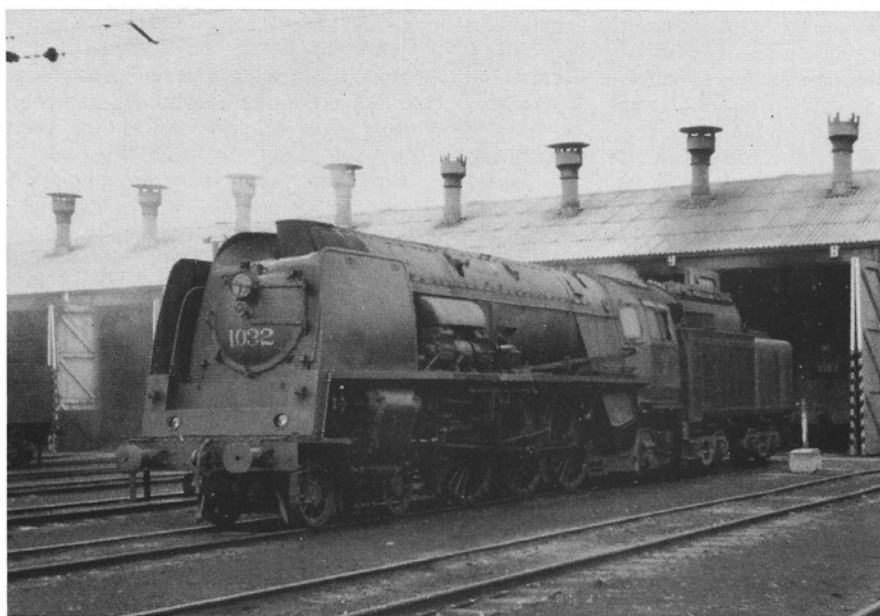
Loc 1.032 in het depot van Brussel Zuid. Bemerkt de A.C.F.I.-voedingspomp op de linkervoetplaat. Achter de frontplaat zijn twee elektrische lantaarns ingebouwd.
