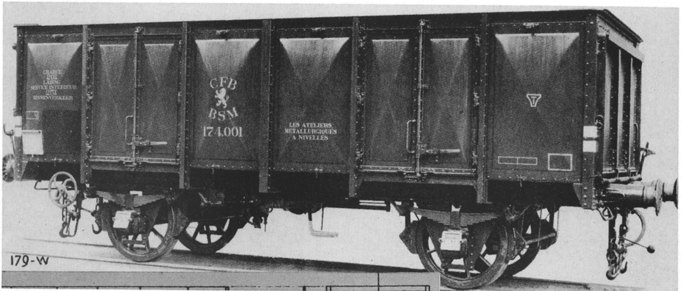
Metalen bakwagen type 1214 A 1, met het opschrift „CFB - BSM”. Foto uit een catalogus van „Les Ateliers Métallurgiques” te Nivelles.
