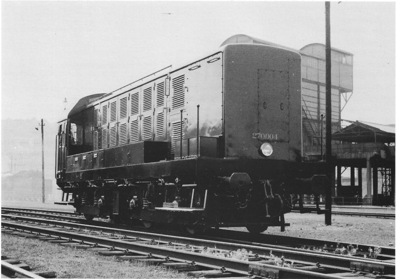
De nieuwe rangeerdiesels type 270 werden door „Baume et Marpent” afgeleverd aan de stelplaats Ronet. Ze deden hier vooral rangeerwerk in de vormingsbundel en voerden eveneens tal van stationsrangeringen uit in Namur. Op deze NMBS-foto is de spiksplinternieuwe 270.004 voorbereid om te worden vereeuwigd door de spoorwegfotograaf.
