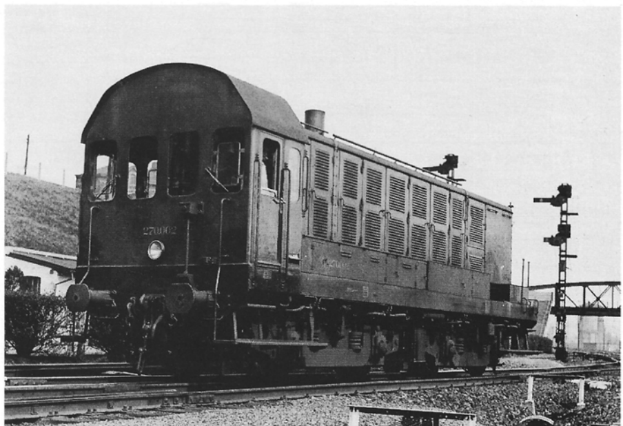
Lokomotief 270.002 staat ongeduldig te wachten op veilig sein in het rangeerstation te Ronet. Op deze foto zijn zeer duidelijk de draaistellen te zien. Het gebruik van bogies is bij een NMBS-rangeerlokomotief eerder ongewoon. De latere reeks 70 bleef dan ook de enige die met draaistellen was uitgerust. Foto NMBS.
