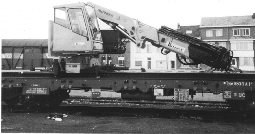
Hasselt goederenkoer : de door „Bonneux Hydraulic Systems” geleverde telescopische kraan op een platte goederenwagen van het type 9830 A 1. Foto Leo Schruers.
