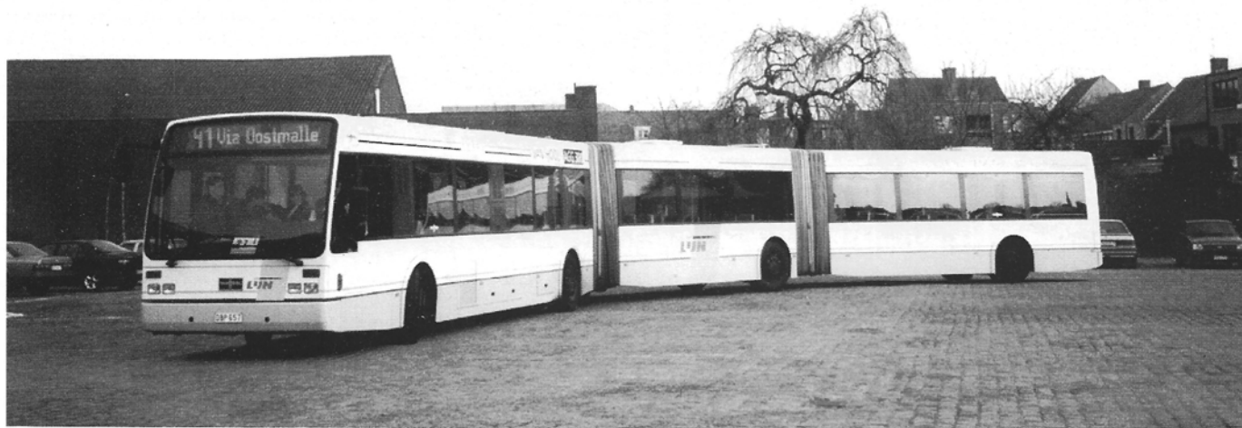
De Van Hool AGG 300 dubbelgelede autobus in de De Lijn-stelplaats Turnhout op 21 maart 1994 : het voertuig is 24,27 m lang ! Foto Marc Heirman.
