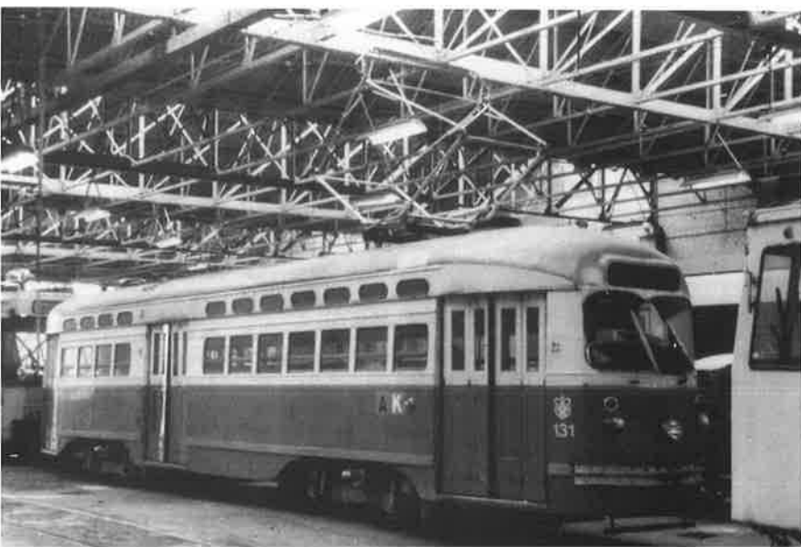
10409, ex-Belgrado 131, in de NMVB-remise te Anderlues op 19 april 1986. Het rijtuig vertoont nog de Joegoslavische livrei, doch is reeds voorzien van een NMVB-stroomafnemer. Foto S. Cuyt.
