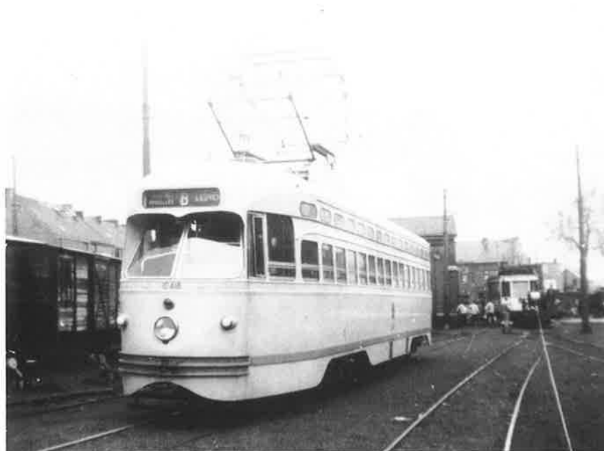
10418 in stelplaats Kessel-Lo. Lijn B Brussel/Bruxelles-Leuven. Nijvere handen zorgen voor het aanbrengen van nieuwe bovenleiding (let op de haspelwagen rechts in het beeld). Foto P. Boehm, archief E. Keutgens.
