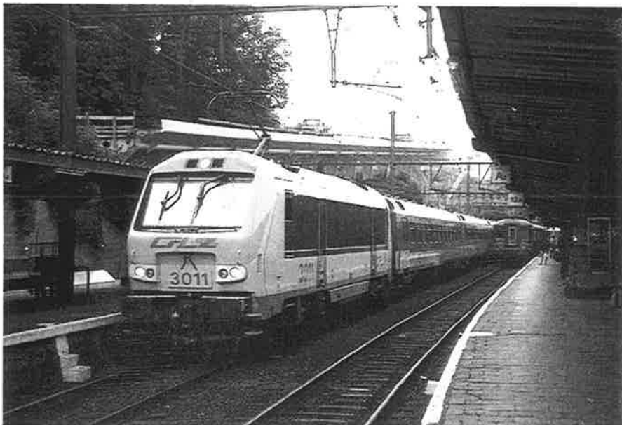
CFL-loc 3011 ontfermt zich te Liège-Guillemins over een stam Nederlandse ICR-rijtuigen die vanuit Amsterdam onderweg zijn naar Luxembourg. Net voorbij Rivage moeten de stroomafnemers even omhoog voor het omschakelen naar 25 kV onder de spanningssluis. Onze reeks 13 en de CFL 3000-locs mogen voorlopig slechts op halve kracht onder de Luxemburgse bovenleiding rijden. 1 juli 2000. Foto : Erik Heylen.
