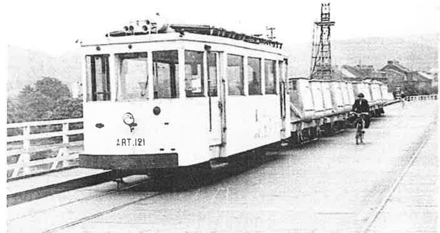
Een mooie opname die illustreert dat naast de bakwagens, platte wagens en gesloten goederenwagens ook specifieke goederenwagens bestonden: ART 121 als trekkracht voor een sleep kipbakwagens. Zowel plaats, datum als fotograaf zijn onbekend; inlichtingen zijn welkom! Verzameling Stefan Justens.
