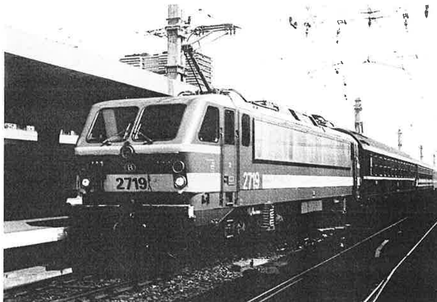
De na een ongeval in februari 1996 in de dienst teruggekeerde loc 2719 is nu voorzien van twee verschillende soorten stroomafnemers : boven stuurstand 2 werd als proef een type Faively AX geplaatst, dezelfde panto die ook bij de nieuwe locomotievenreeks 13 zal worden gebruikt. Brussel Noord, 26 mei 1997, foto Alain Janmart.
