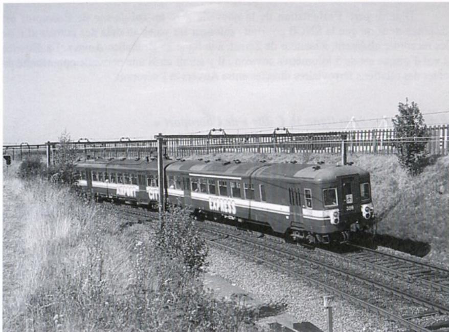
**Une automotrice électrique (série 595 à 600), alors spécialisée « Airport Express », sur la ligne 36C actuelle ; on remarquera la caténaire « surbaissée » dans cette zone de décollage et d'atterrissage des avions (photo M. Van Ussel - 20.09.91)**
