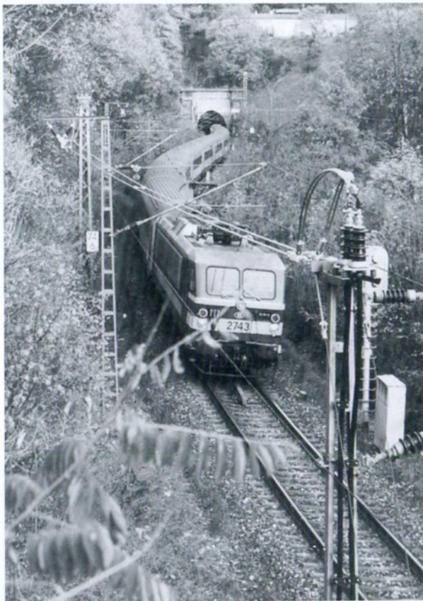
Ronheide (D) : Le train IC Cologne - Ostende débouche du Buschtunnel et aborde le saut-de-mouton de changement de sens de circulation (locomotive belge 2743 sous caténaire DB - 3 kV et voitures I 11 - photo M. Grieten - 05.11.99)
