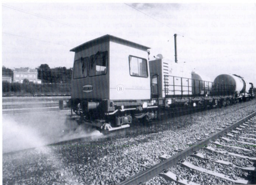
Le nouveau wagon nettoyeur de rails de la SNCB (photo D. Moinil)
