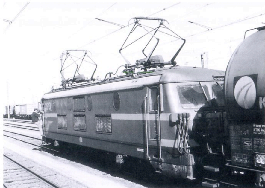
Anvers Faisceau Rhodésie : la 2313 en tête d'un train de fret (remarquons la 4 ème ouïe de ventilation entre les deux hublots centraux (photo M. Grieten - 20.09.97)
