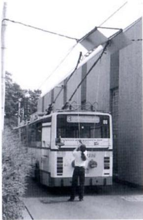
← Dispositif de positionnement des perches de trolleybus à la sortie du dépôt de Gentbrugge
