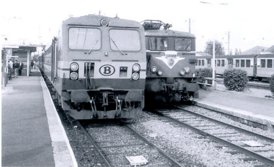
Le 19.07.1996, à Aulnoye-Aimeries, l'ancien international de proximité pour Mons, assuré par rame réversible M4 et locomotive bicourant série 12 de la SNCB photo R. Marganne
