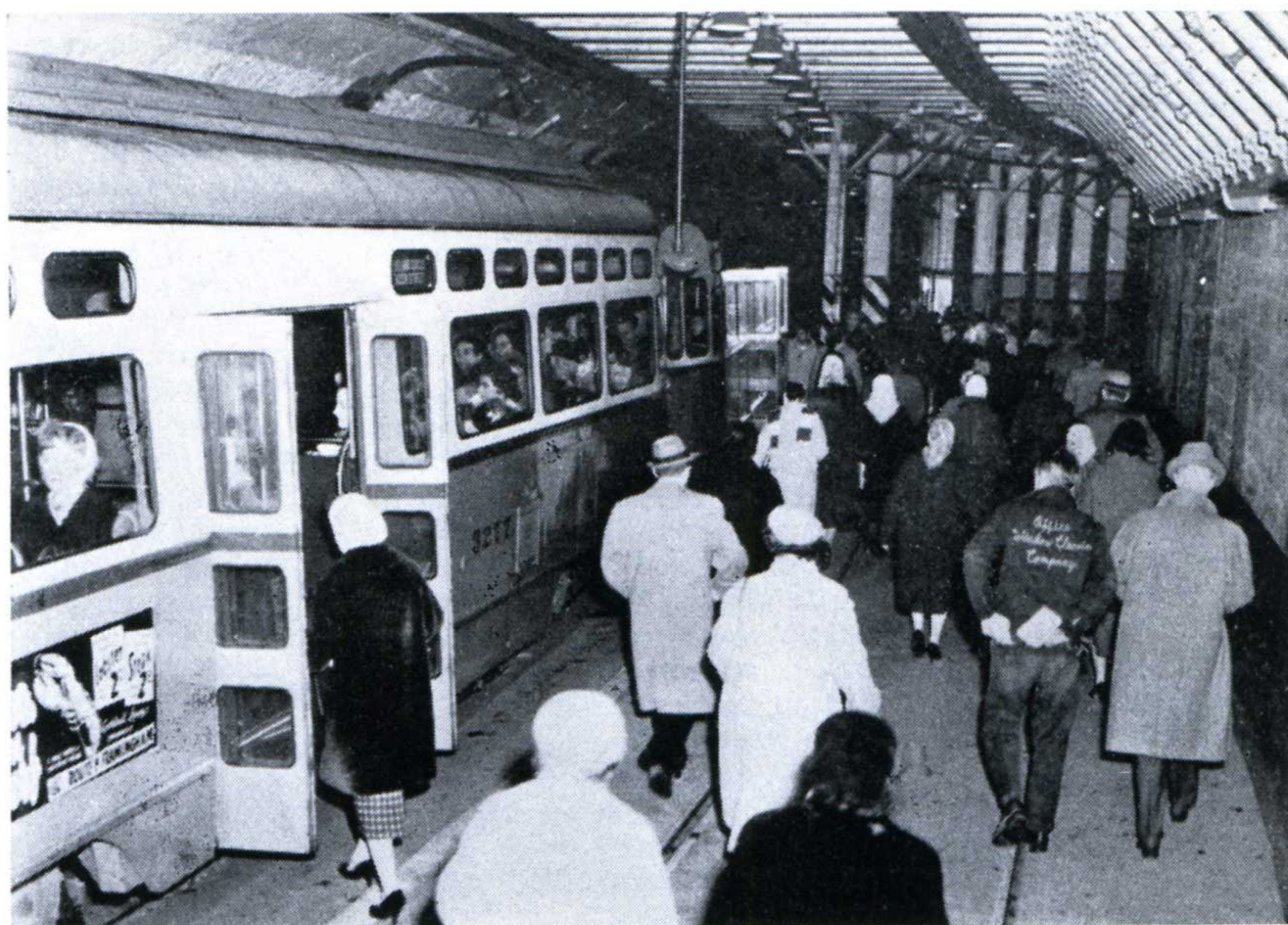
Station souterraine du pré-métro de Boston ; rame de trois motrices modernes ; à noter qu'une porte est prévue dans le long pan de gauche pour être utilisée dans certaines stations comme celle-ci.
