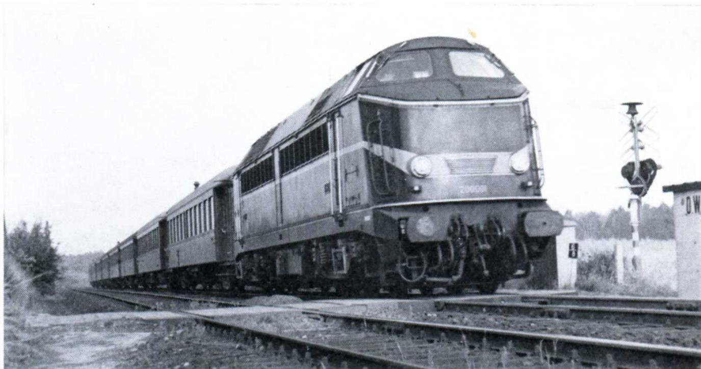
service express ; cet autorail est muni d'un moteur diesel avec transmission électrique.
