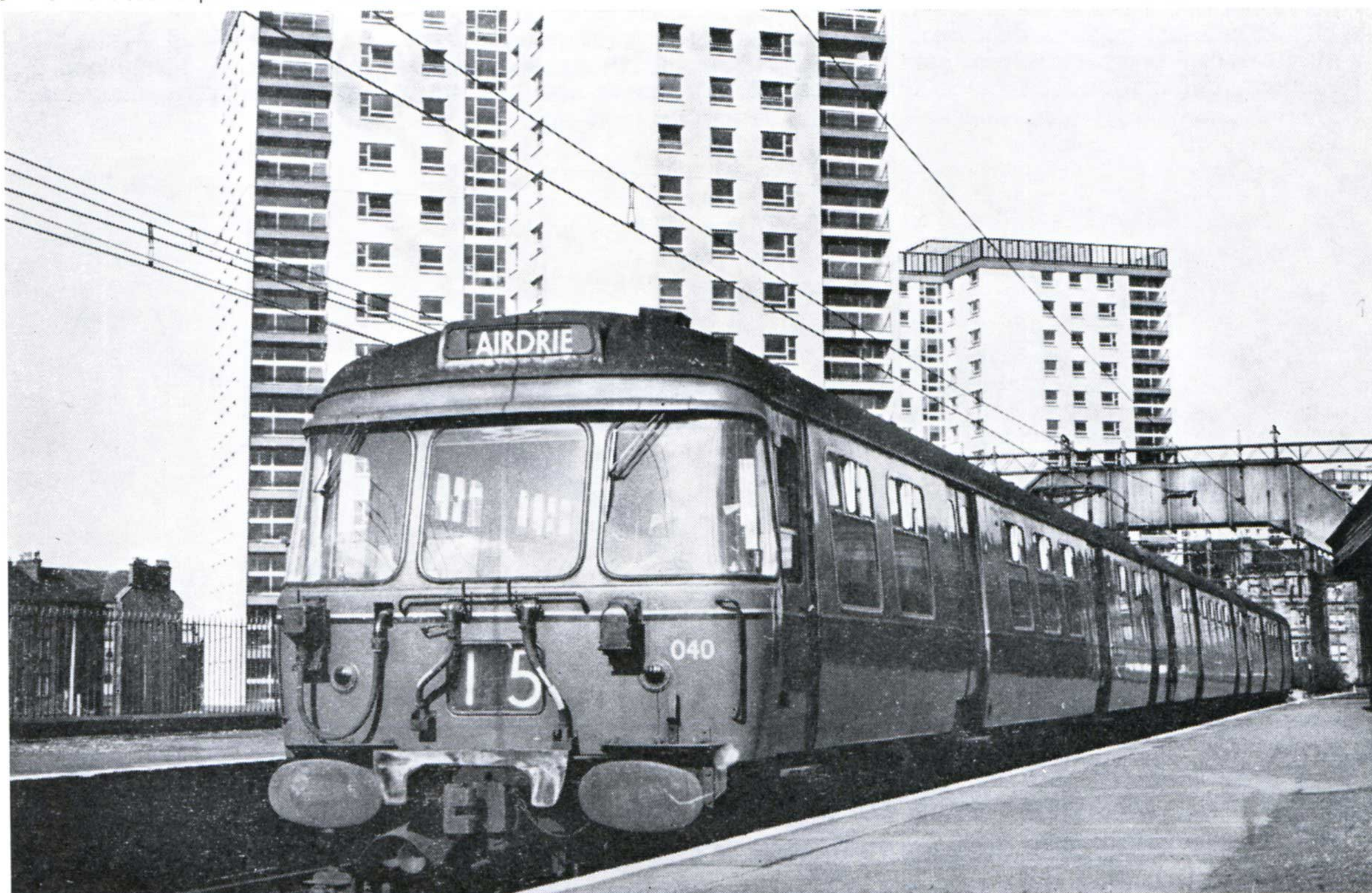
Rame automotrice triple 25 kV 50 Hz des British Railways en service dans la banlieue de Glasgow - station de Dalmeir Park ; on notera l'esthétique de ces véhicules (photo British Railways)
