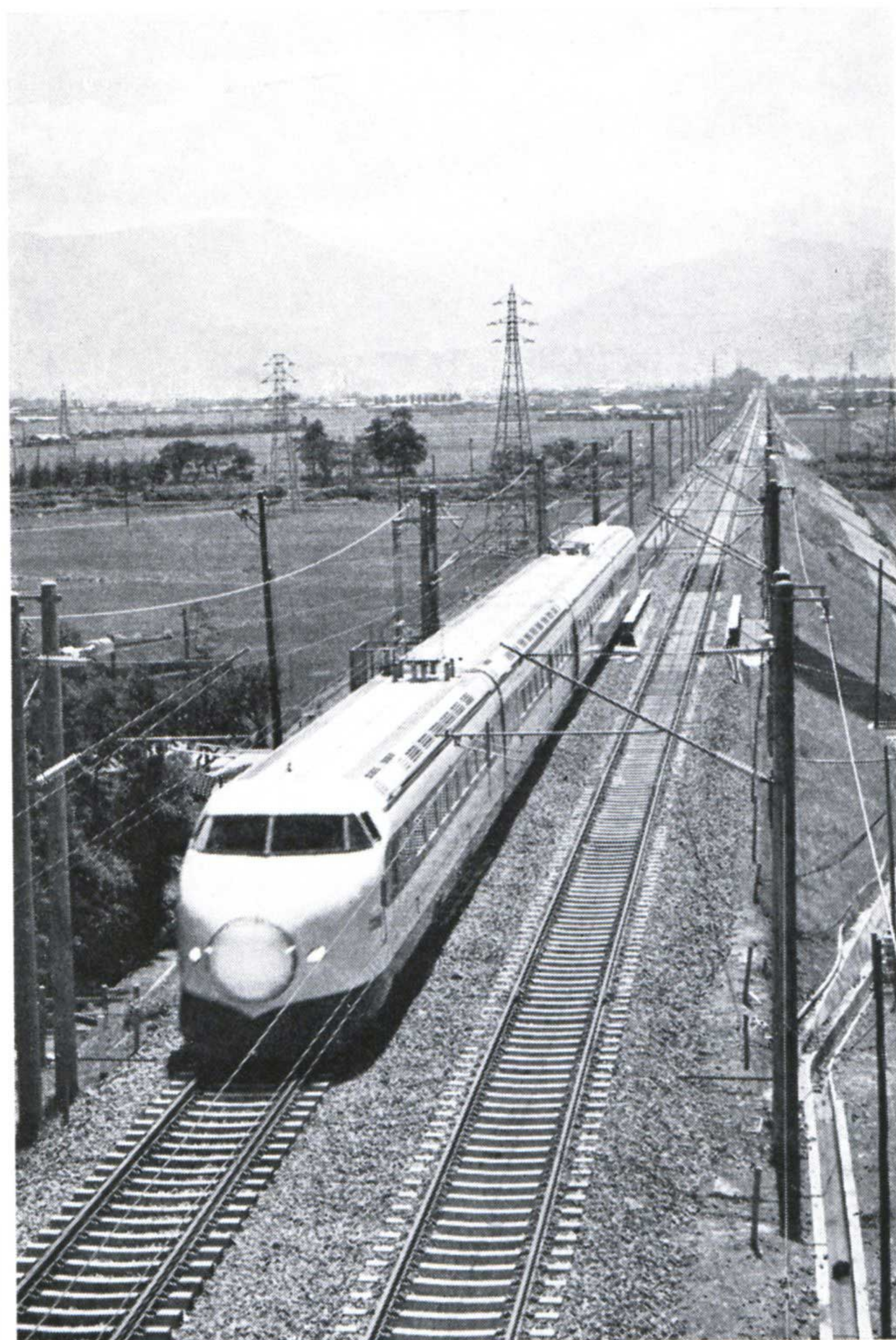
Le N.T.L. ou plus familièrement le « Tokaïdo » qui révèle à tous les chemins de fer que celui qui veut, peut ici, rame quadruple du type B, en vitesse sur la nouvelle ligne du Tokaïdo ; on remarquera l'exceptionnelle largeur du matériel (3,40 m) et l'entraxe des voies porté à 4,20 m. (cliché R.T 83001)
