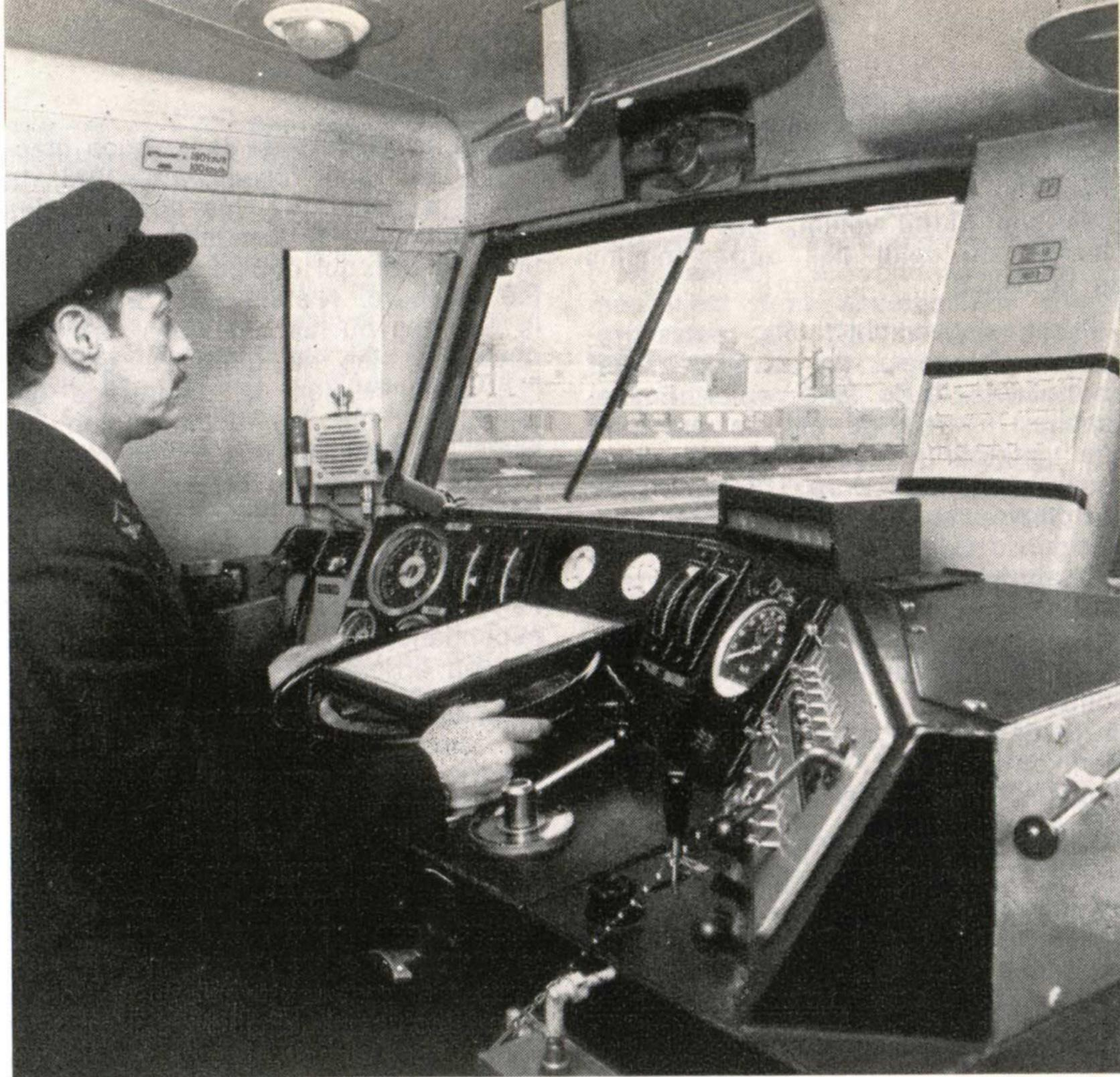
**Pupitre de commande de type fonctionnel. Le volant du manipulateur entoure la planche destinée à recevoir les livrets de marche.** Photo SNCB.
