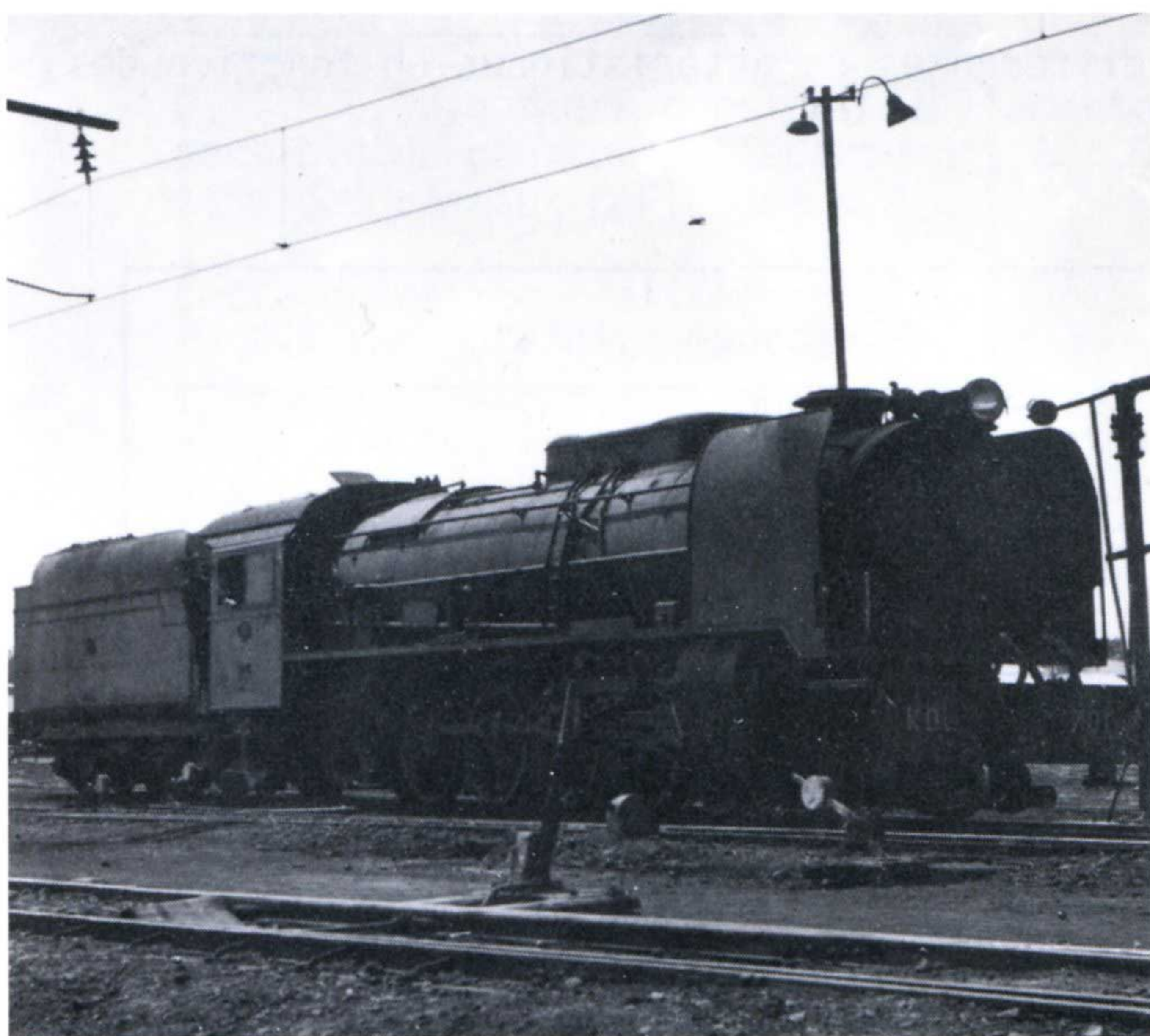
Locomotive Type 2.4.1. du KDL. (94 t. voie de 1.067 m).
