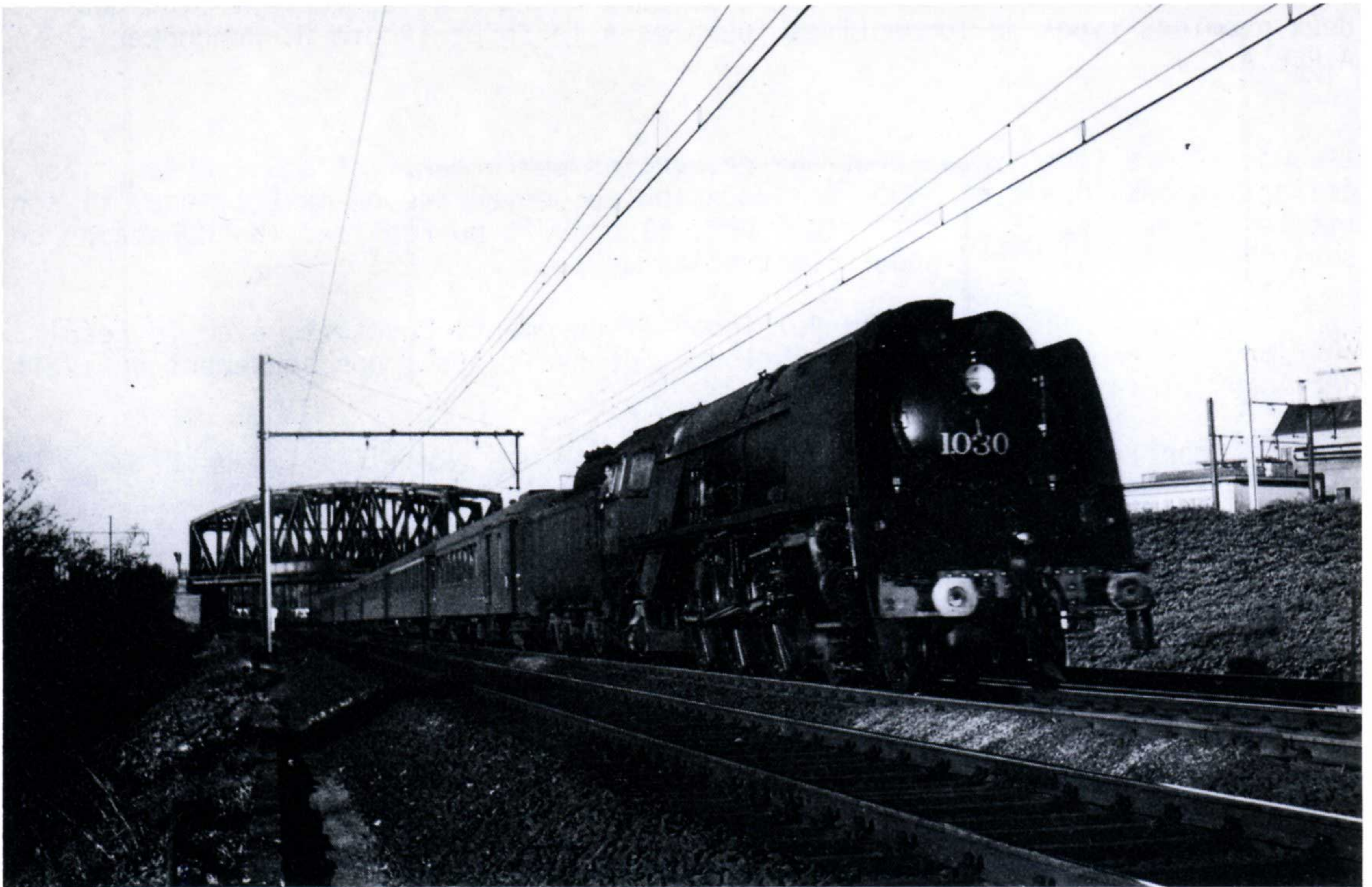
Locomotive type 1, de l'Ingénieur Notesse, mise en service à partir de 1935, à l'occasion du centenaire des chemins de fer belges. Construites par le "Consortium belge des constructeurs de locomotives", elles étaient destinées à la remorque de trains rapides de 600 t à 120 km/h ou de 350 t à 140 km/h. (Photo B. Dedoncker - A.R.B.A.C.).
