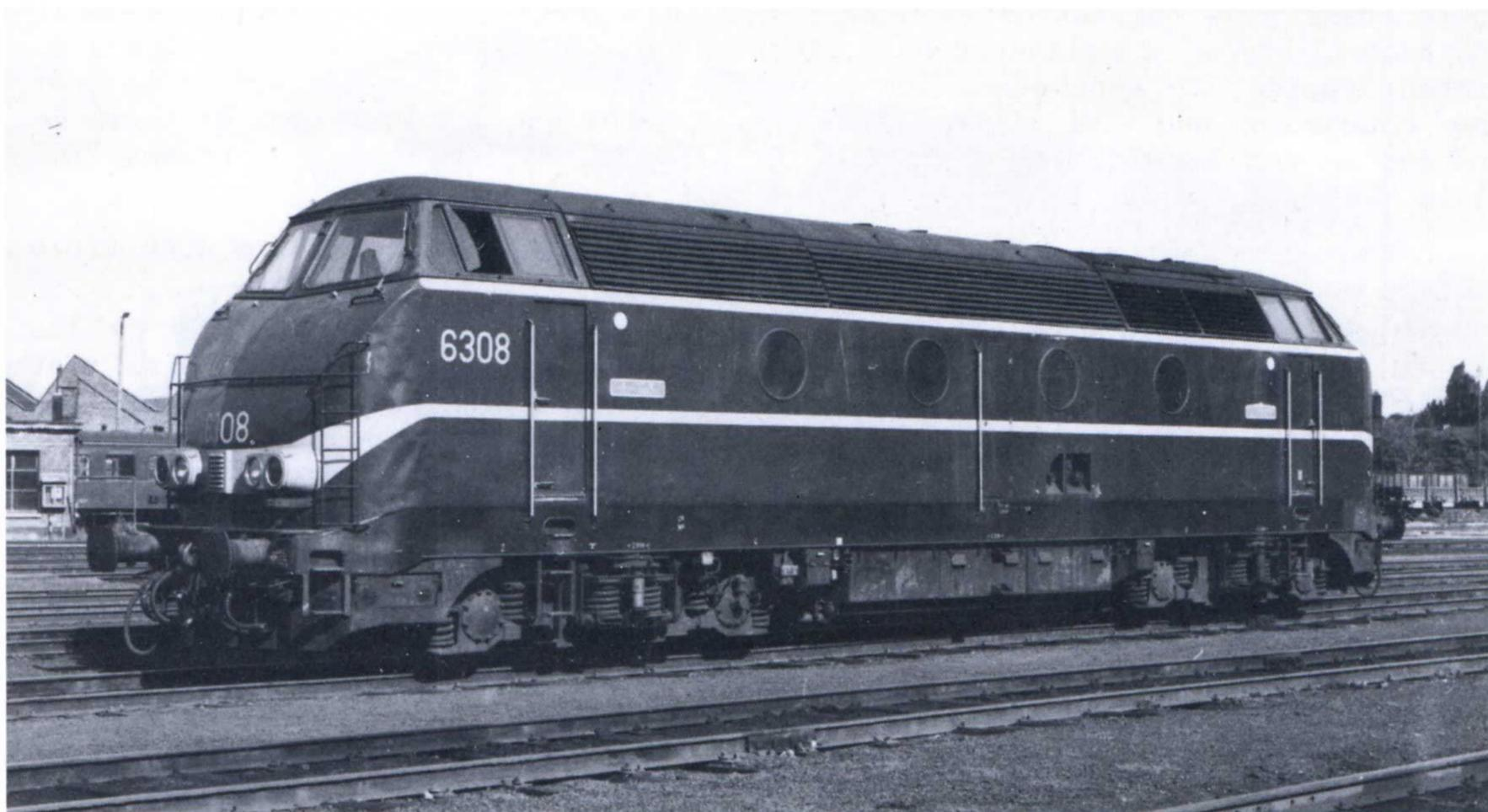
Le type 212, devenu les séries 62/63, est celui qui compte le nombre le plus élevé de locomotives: 136 à la construction (6 prototypes livrés en 1961, 75 machines en 1962-64 et 55 en 1965-66).
