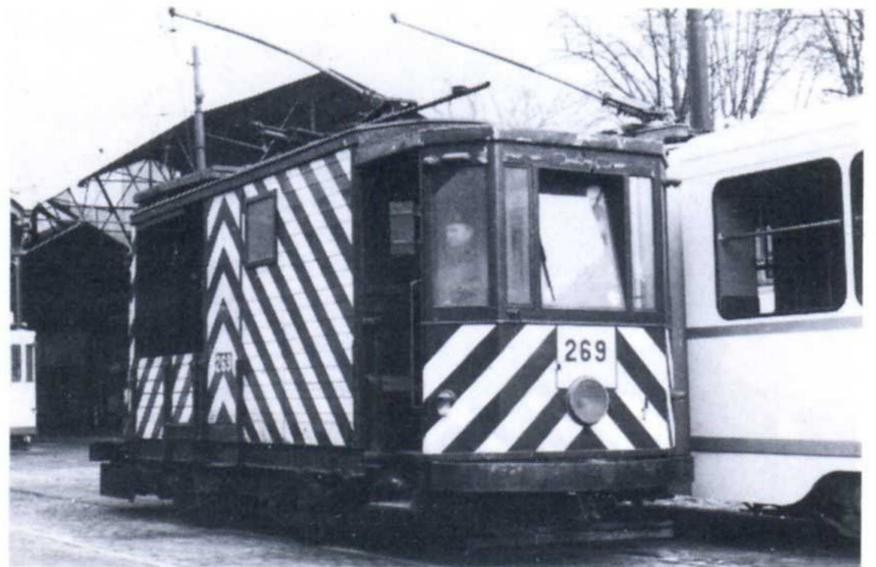
Motrice-échelle 269 : noter la seconde perche de trolley, couchée sur la toiture.
