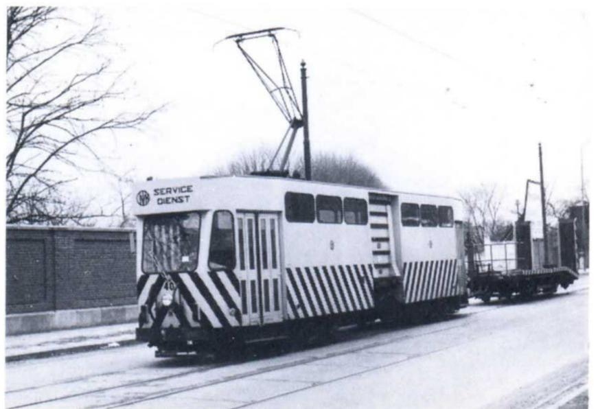
Motrice à bogies 40 remorquant, par l'intermédiaire d'une barre de traction, le wagon 144.
