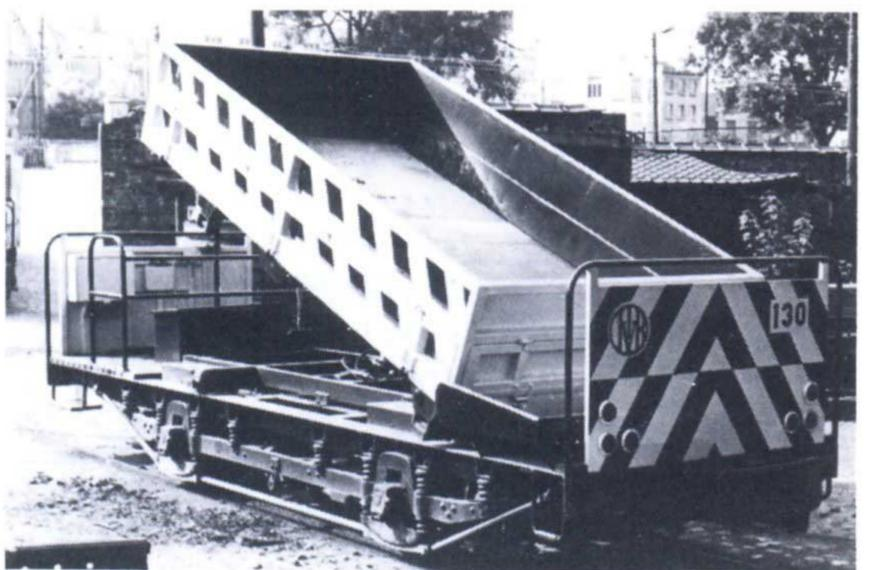
La benne unique du wagon à ballast 130 est orientable dans trois directions.
