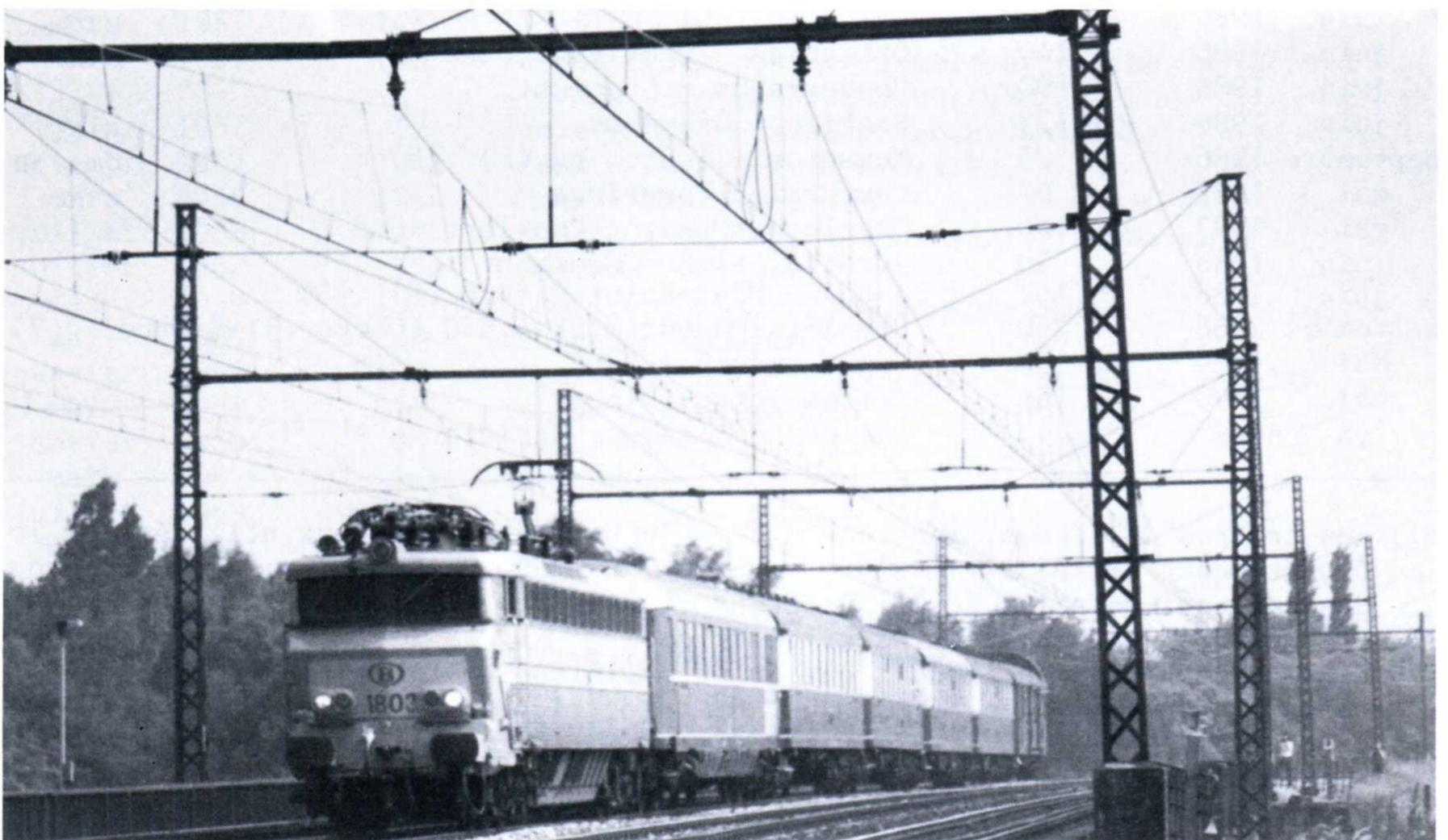
Les lignes 25 et 27 disposent, à hauteur de Duffel, de sept portiques en treillis métallique supportant la caténaire au-dessus des quatre voies. Exceptionnellement, la 1803 y achemine la rame historique "Rheingold", en direction d'Anvers-Est. (Photo C. Dosogne)
