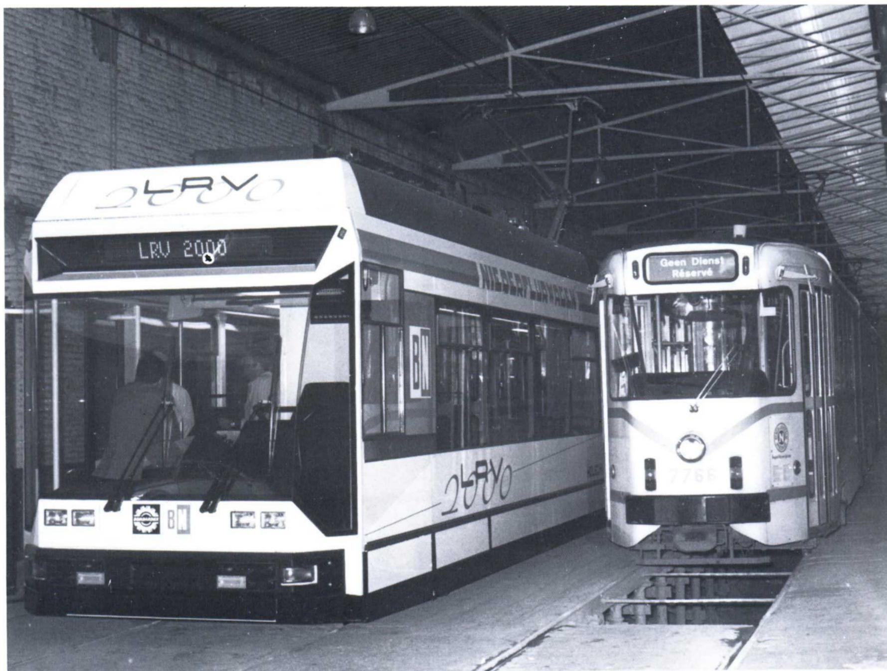
Fin août 1990, le prototype de tramway à plancher surbaissé, mis au point par la S.A. "Constructions Ferroviaires et Métalliques" (BN), a séjourné quelques jours à Bruxelles pour y réaliser des essais de nuit au départ du dépôt de l'avenue de l'Hippodrome. (Photo G. Bricman)
