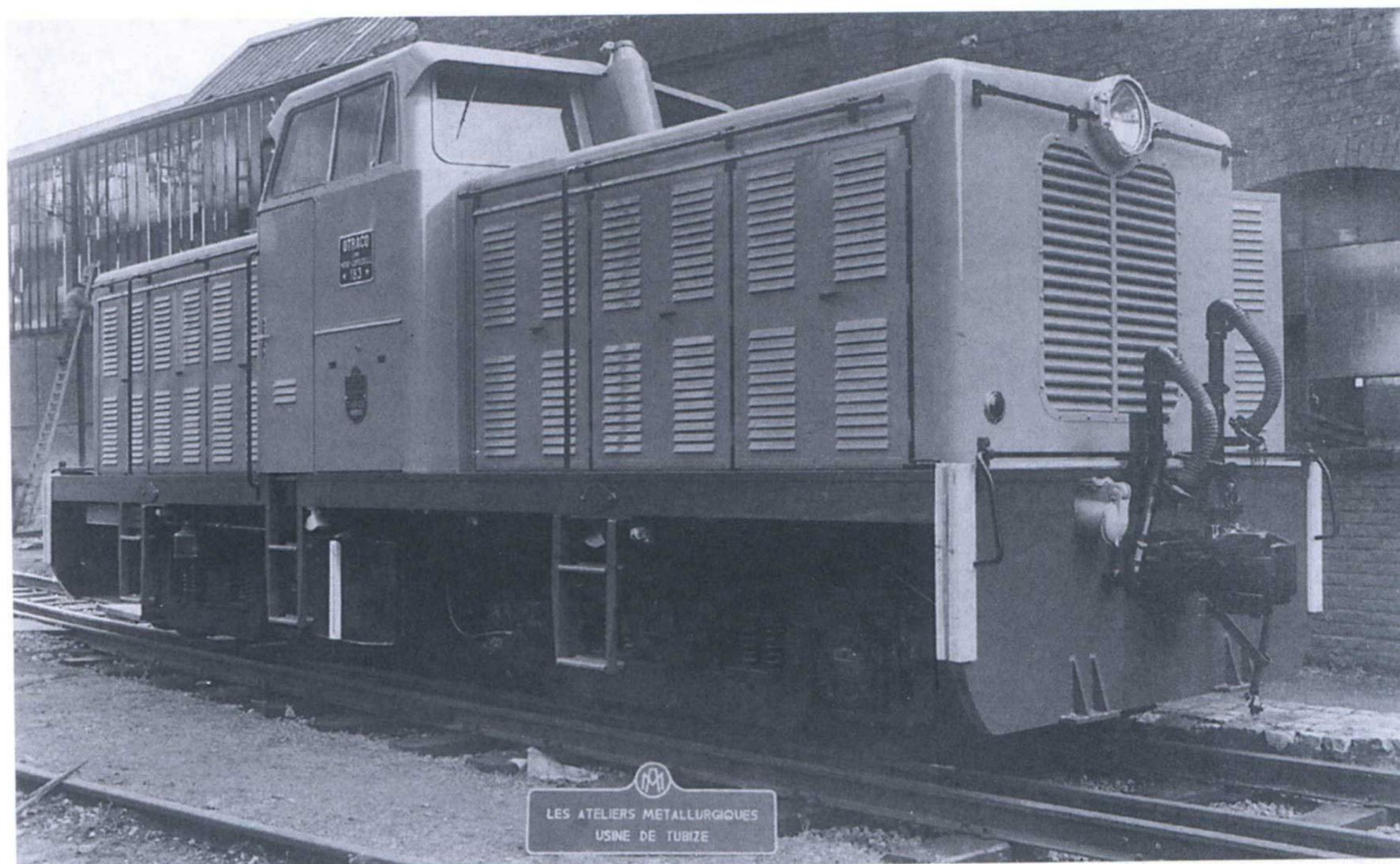
*Aux Ateliers Métallurgiques, à Tubize, locomotive BoBo diesel-mécanique de manoeuvre, n° 183 (50 tonnes, 500 ch).*
