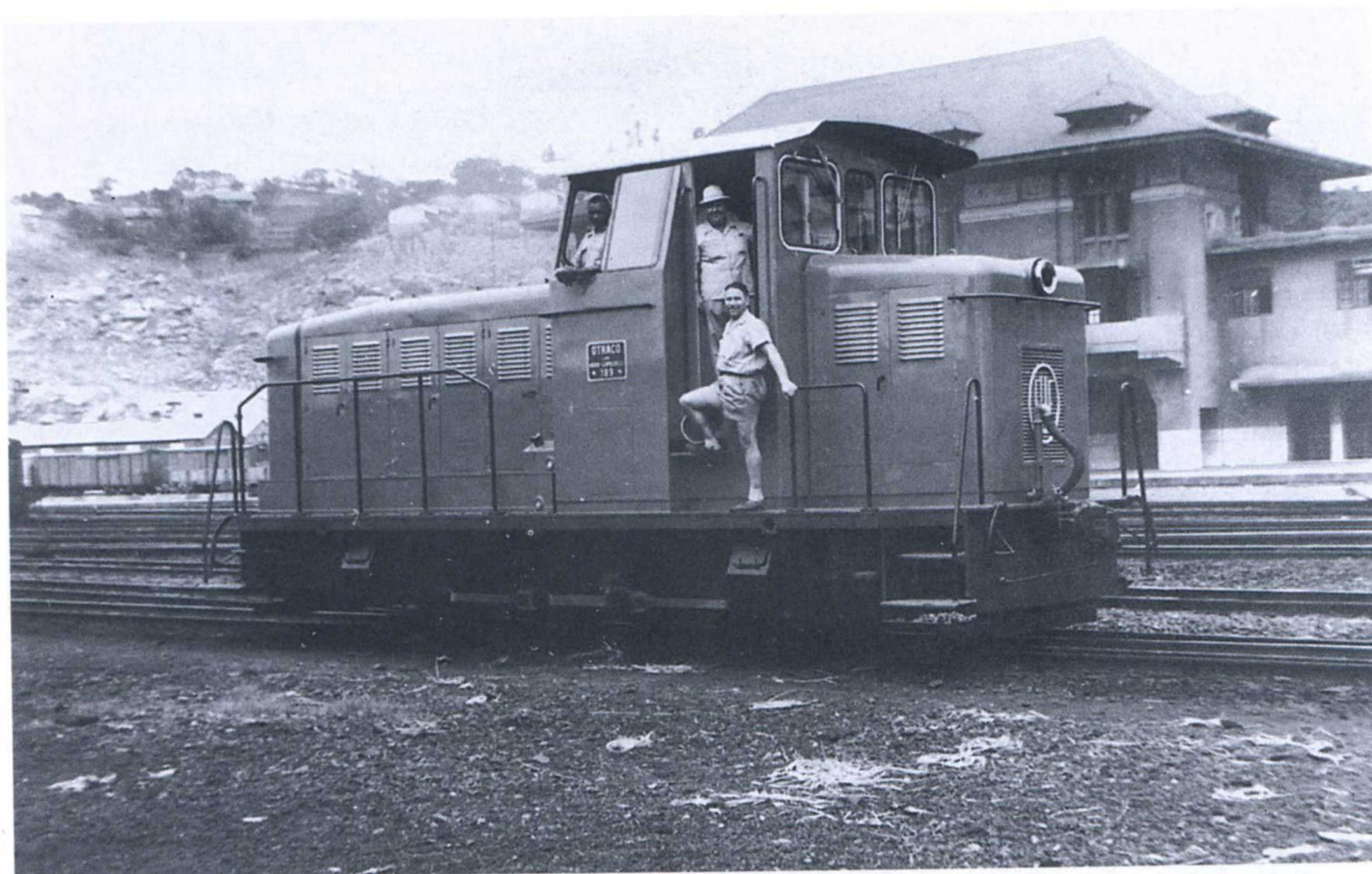
*A Matadi en 1959, locomotive de manoeuvre n° 189, construite par F.U.F. à Haine-Saint-Pierre (type 0-C-0, 45 tonnes, 455 ch, transmission Voith hydromécanique)*
