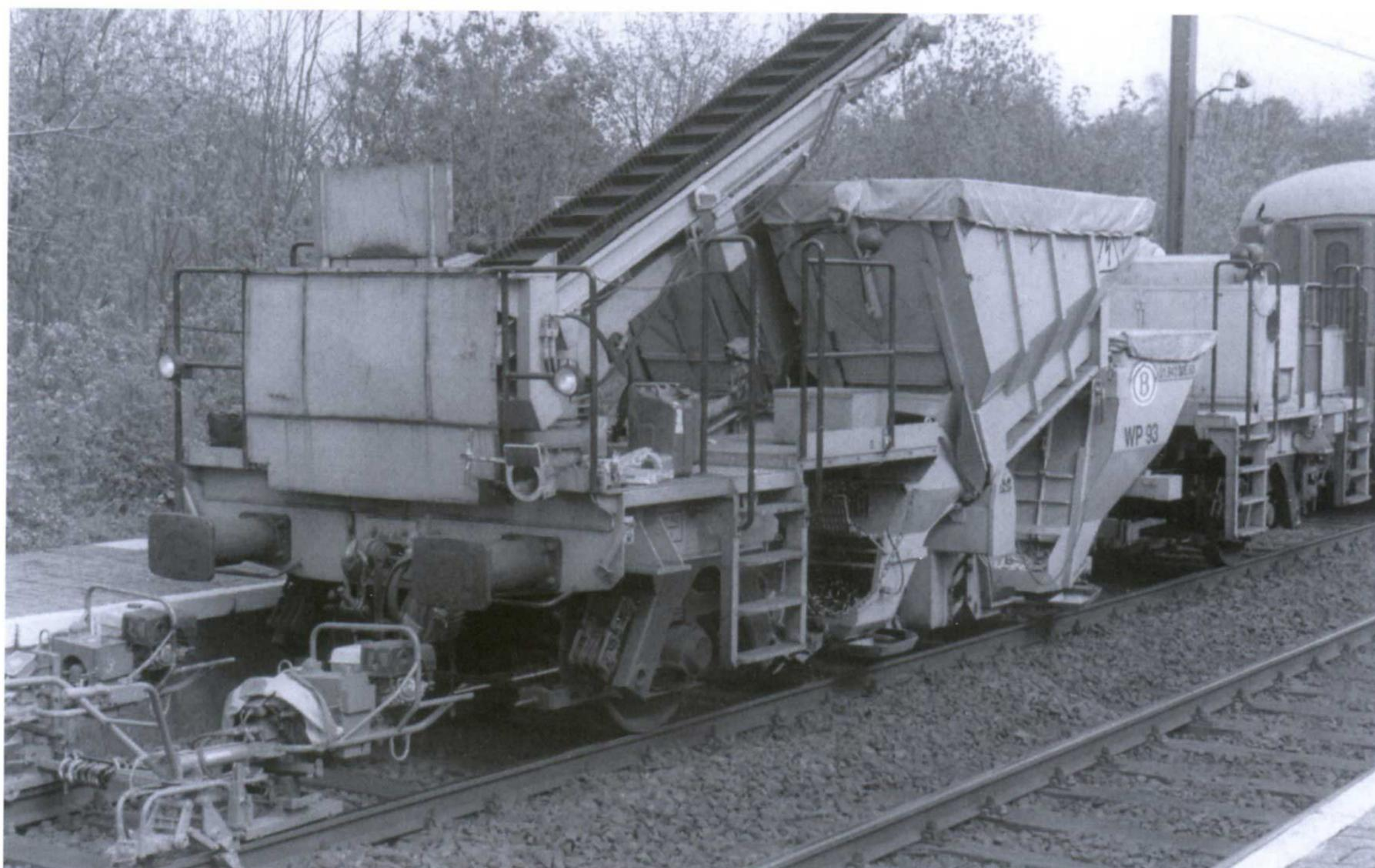
*Le wagon "PANDROL" WP 93 permet d'accélérer sensiblement les travaux de manipulation des attaches du même nom, qui assurent la fixation des rails aux traverses.*
