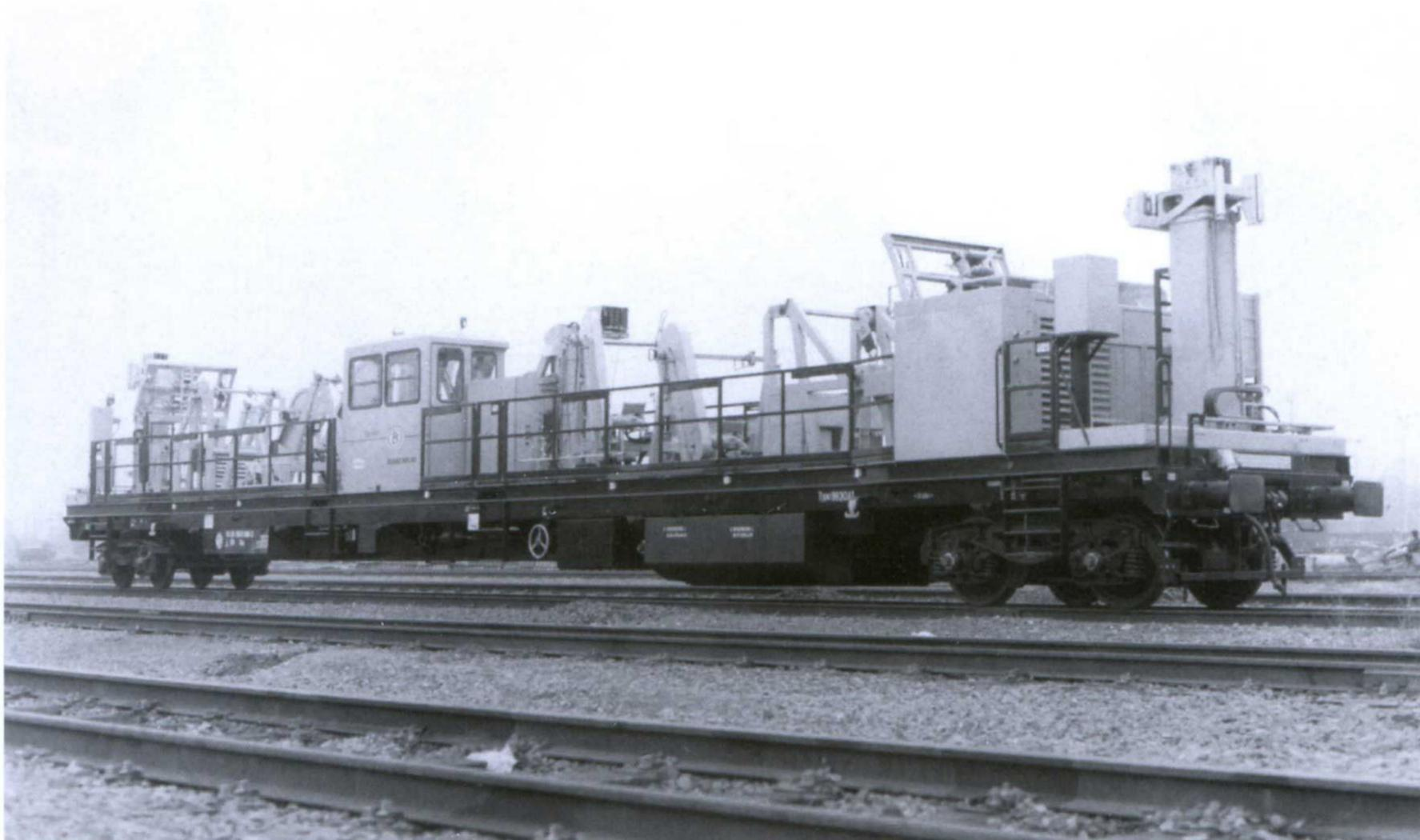
*Wagon enrouleur/dérouleur, non encore équipé de tourets de câbles; capable de se mouvoir de manière autonome (5 km/h), il peut dérouler et enrouler simultanément.*
