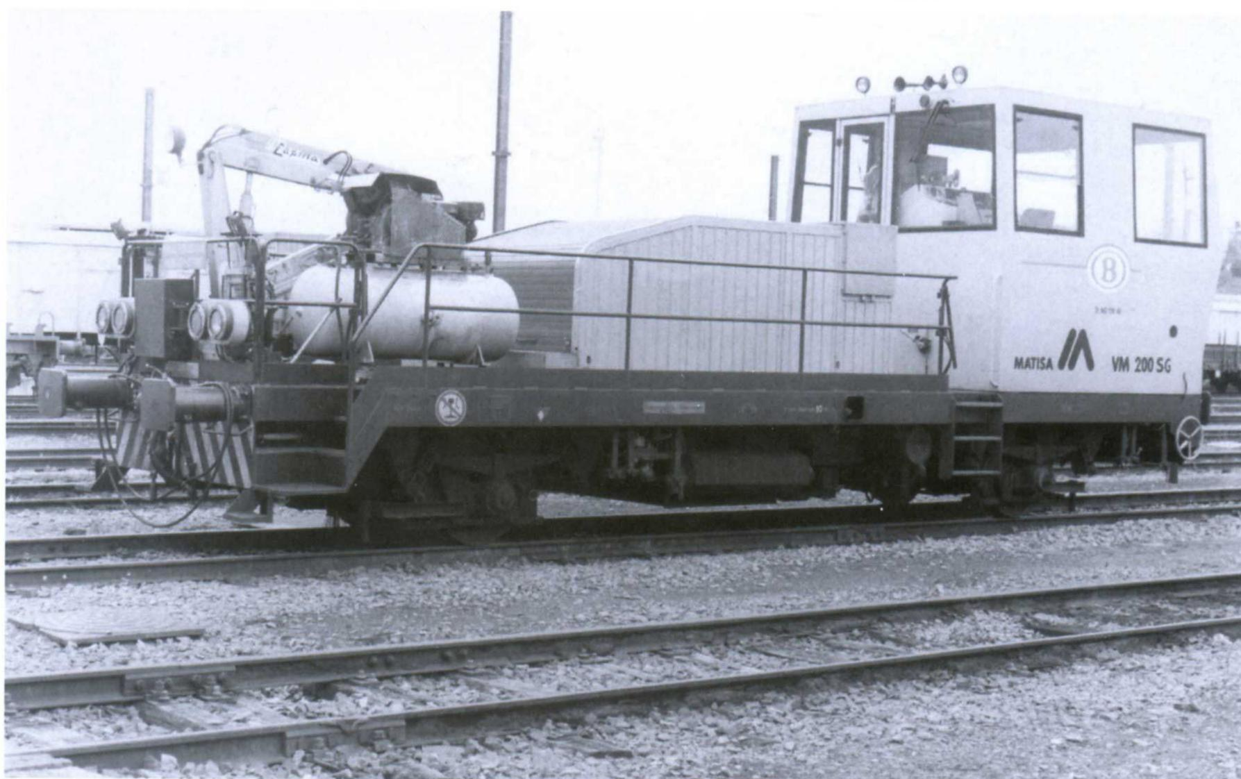
*Construit par MATISA en 1998, cet engin automoteur est destiné à l'alimentation des "graisseurs de rails". Ces dispositifs sont placés à l'entrée des courbes et permettent de réduire l'usure latérale des rails, en répandant à chaque passage de roue une petite quantité de graisse sur la face de guidage du rail de la file extérieure.*
