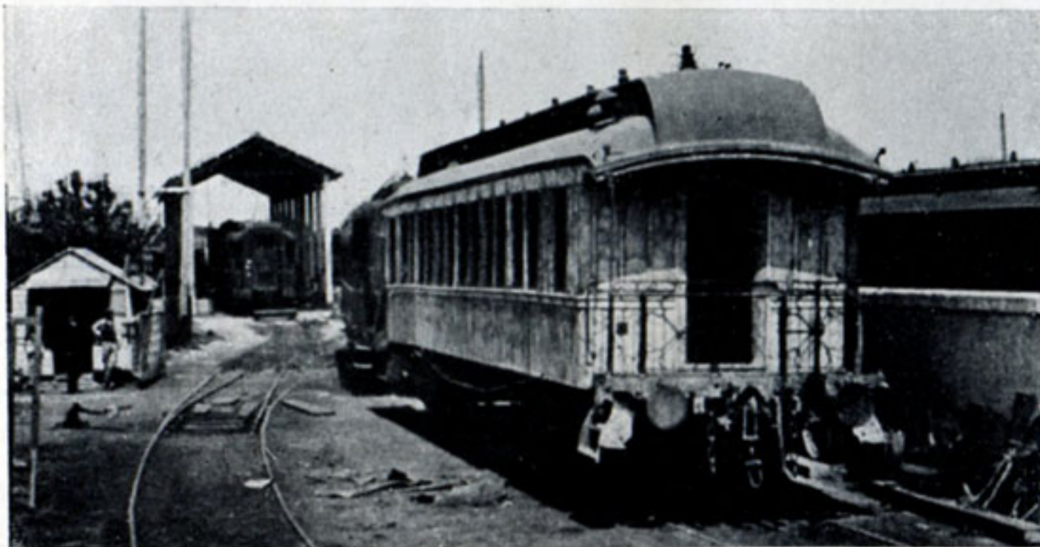
Voiture Pullman, série 198 à 207, construite aux Etats-Unis vers 1877, rachetée par la Cie WL en 1886, en service sur la « Malle des Indes » de 1887 à 1892. Quatre voitures de cette série furent vendues au Cirque Mac Caddon's après réforme. (Photo Ateliers de Rome, archives WL, cliché Chemins de fer.)
