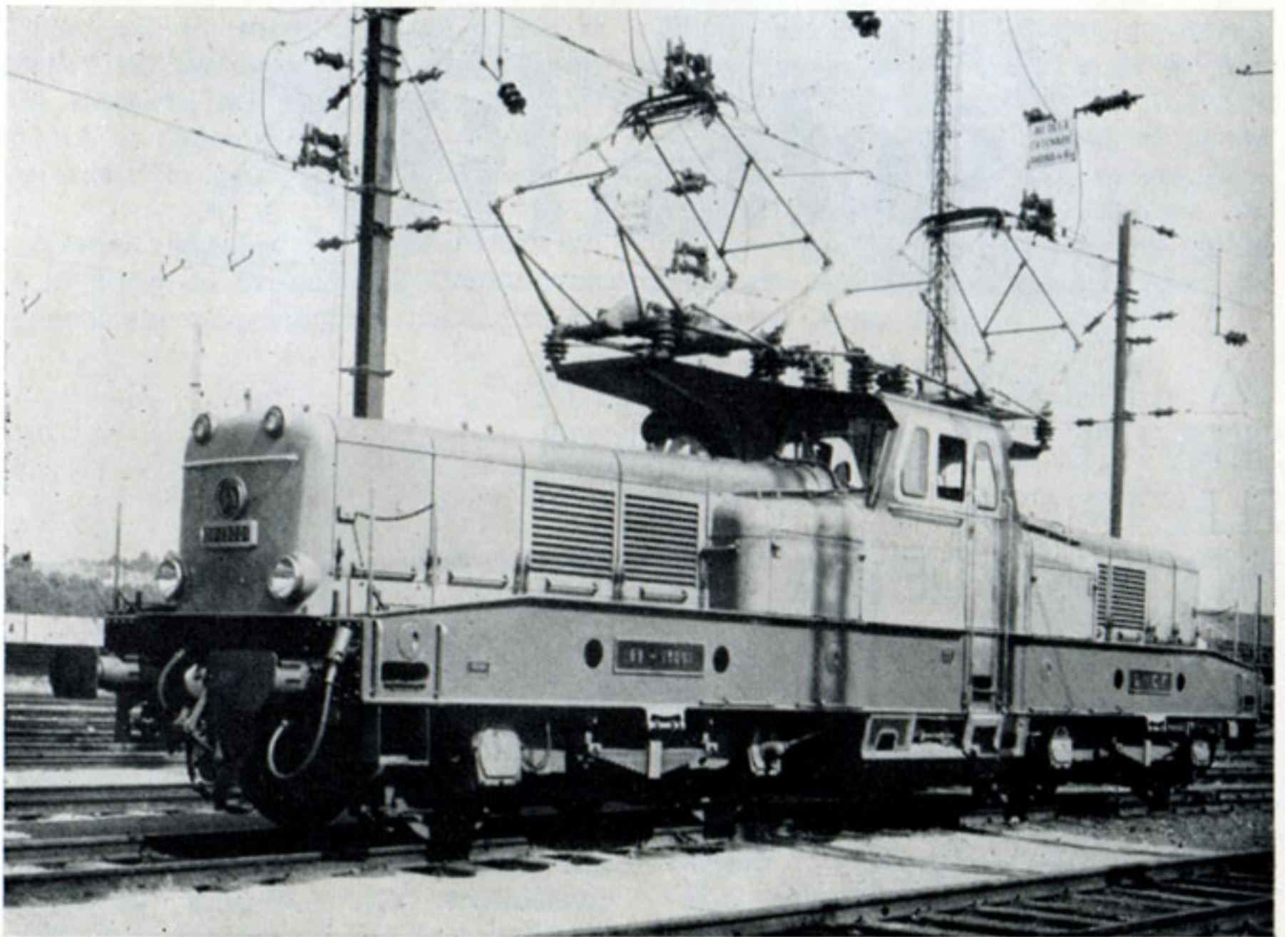
Nouvelle locomotive BB 13001 de la S. N. C. F. - 25.000 volts, 50 périodes. (Photo S.N.C.F.)
