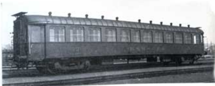
Fig. 1. — Voiture métallique de 3e classe - service international de la S.N.C.B. (Photo S.N.C.B.)
