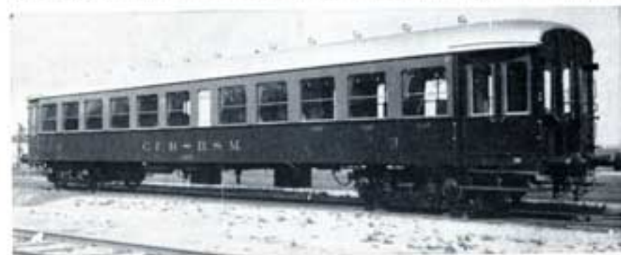
Fig. 2. — Voiture métallique de 3 e classe - service intérieur de la S.N.C.B. (Photo S.N.C.B.)
