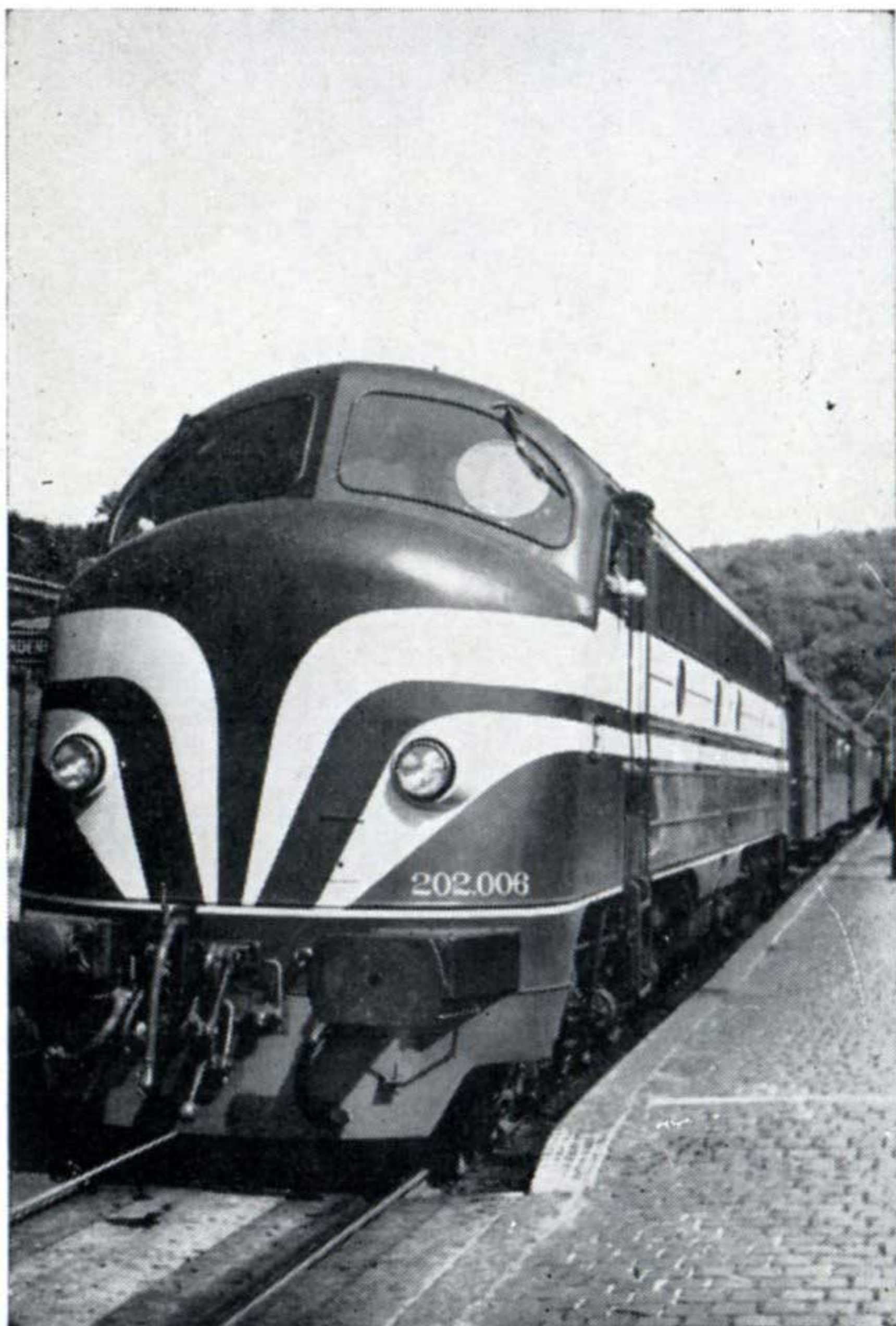
Locomotive diesel-électrique de 1750/ 1600 HP AFB-GM pour la Société Nationale des Chemins de Fer Belges (Photo H.F. Guillaume)
