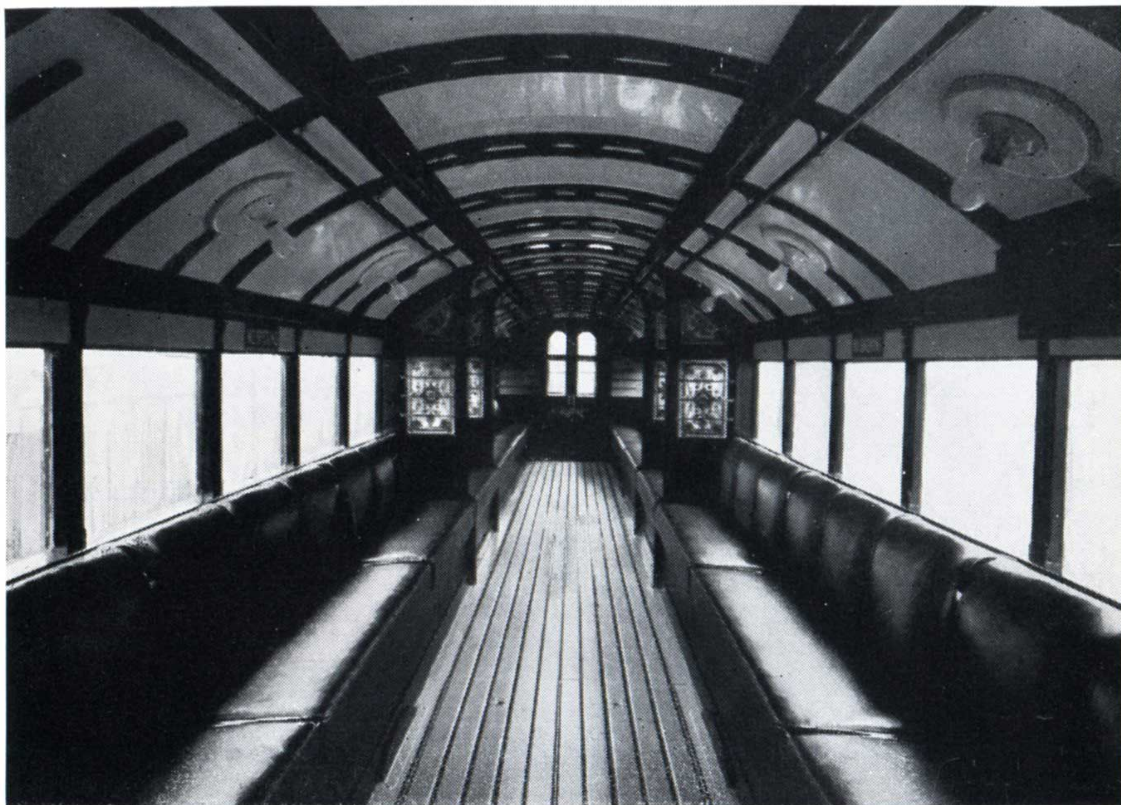
Intérieur de la voiture de la page précédente; le matériel roulant comprend actuellement 25 motrices et 24 remorques provenant du matériel à câble mais muni de nouveaux bogies. (Cliché « Railway Magazine »)
