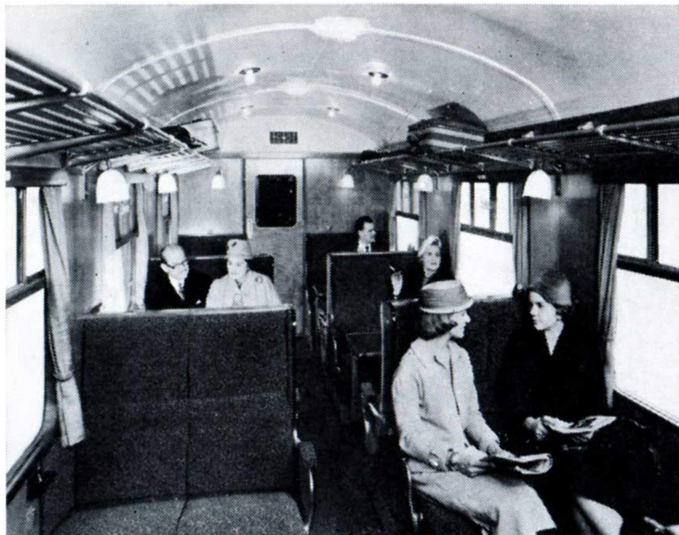
Un des compartiments de 2 me classe des rames sextuples de Hastings. La largeur réduite a imposé 4 places de front, mais plus confortables que la normale. (Photo British Railways, S. Region)
