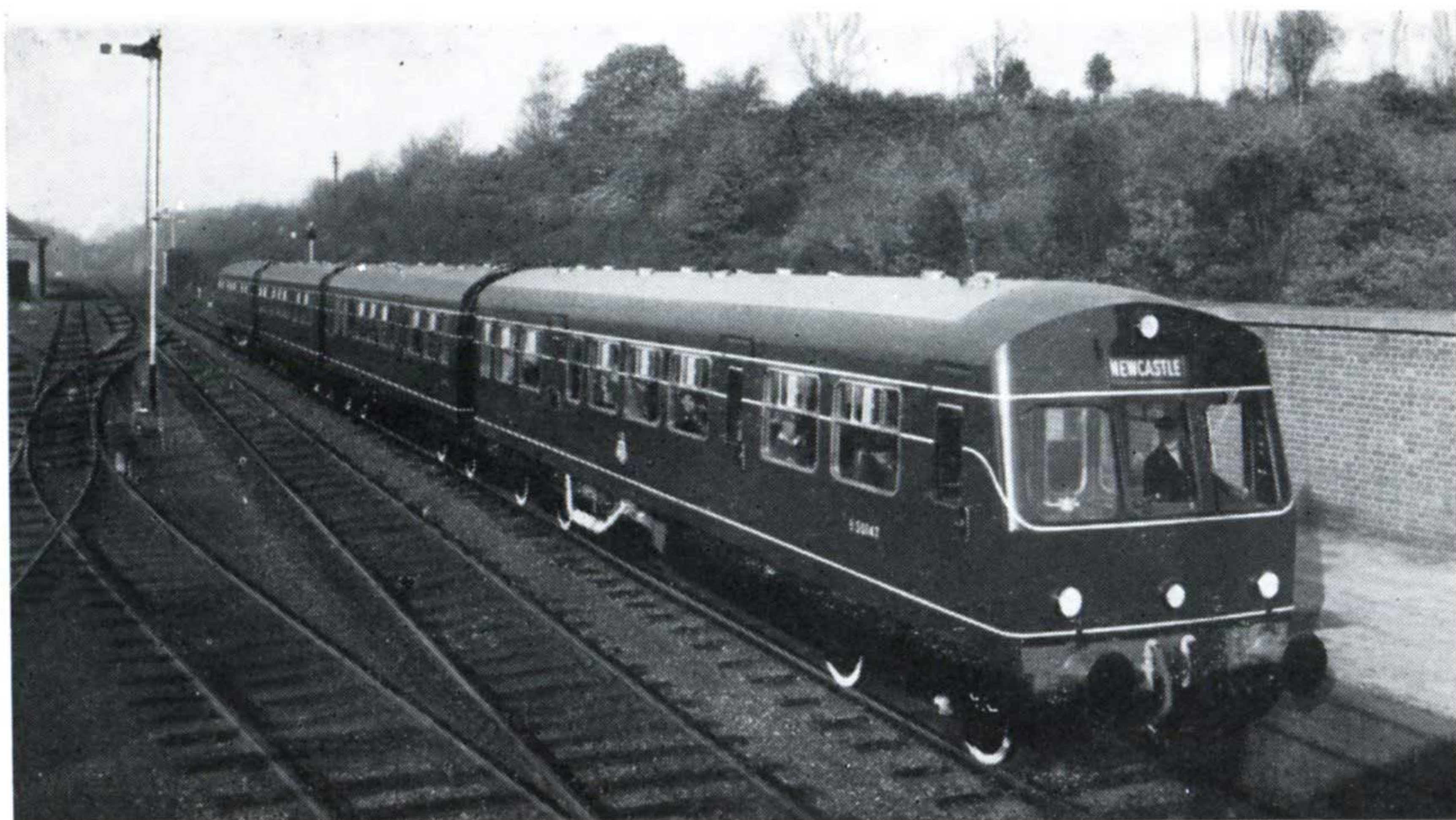
Autorail quadruple pour la NE Region — 24 + 222 places — 114 tonnes — 600 ch. (Photo Metropolitan Cammell)
