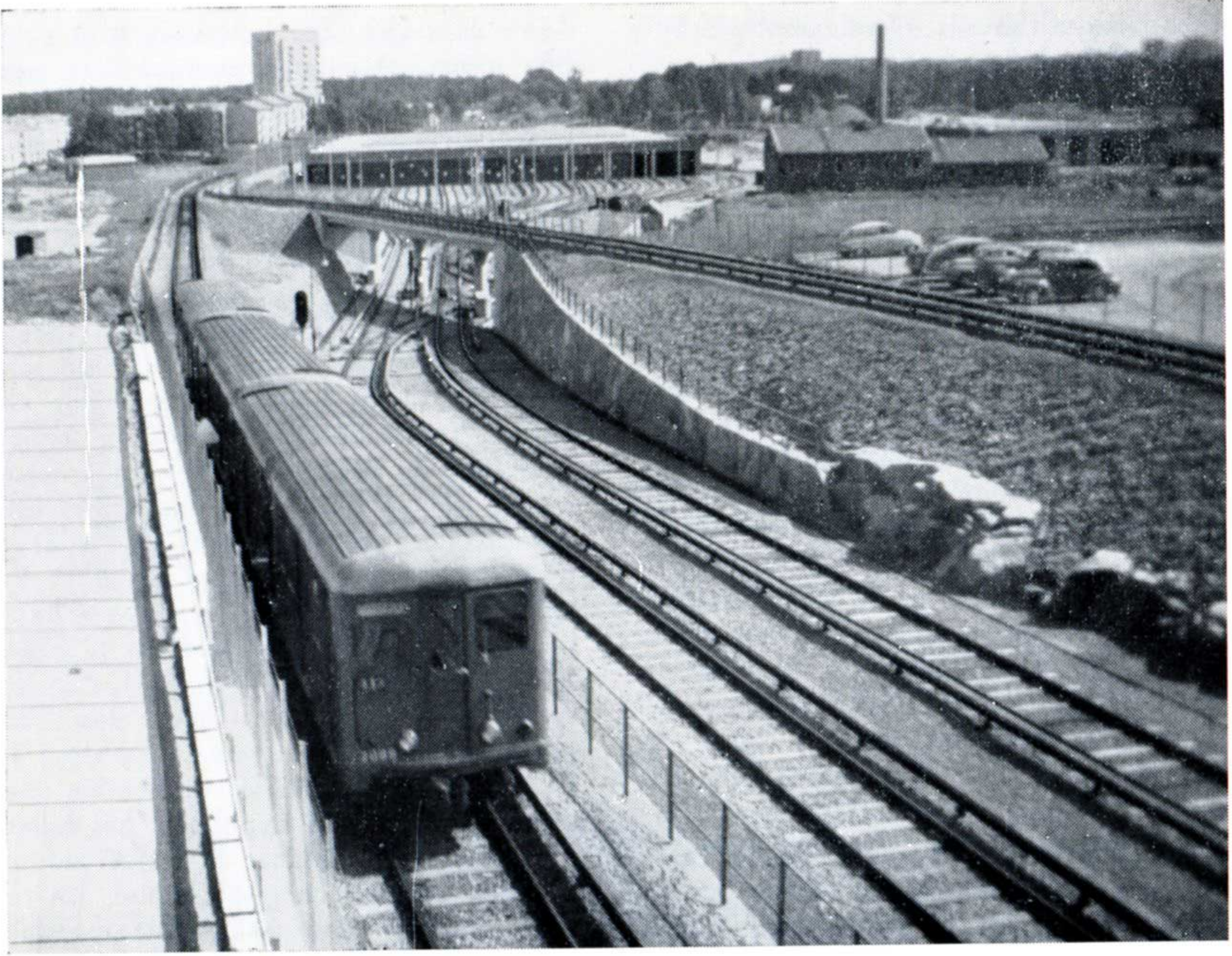
Train de trois voitures se dirigeant vers Stockholm — dans le fond, le dépôt attenant à la station de Vällingby — Les 26 voies peuvent abriter 208 voitures de métro. (Photo de l'auteur)
