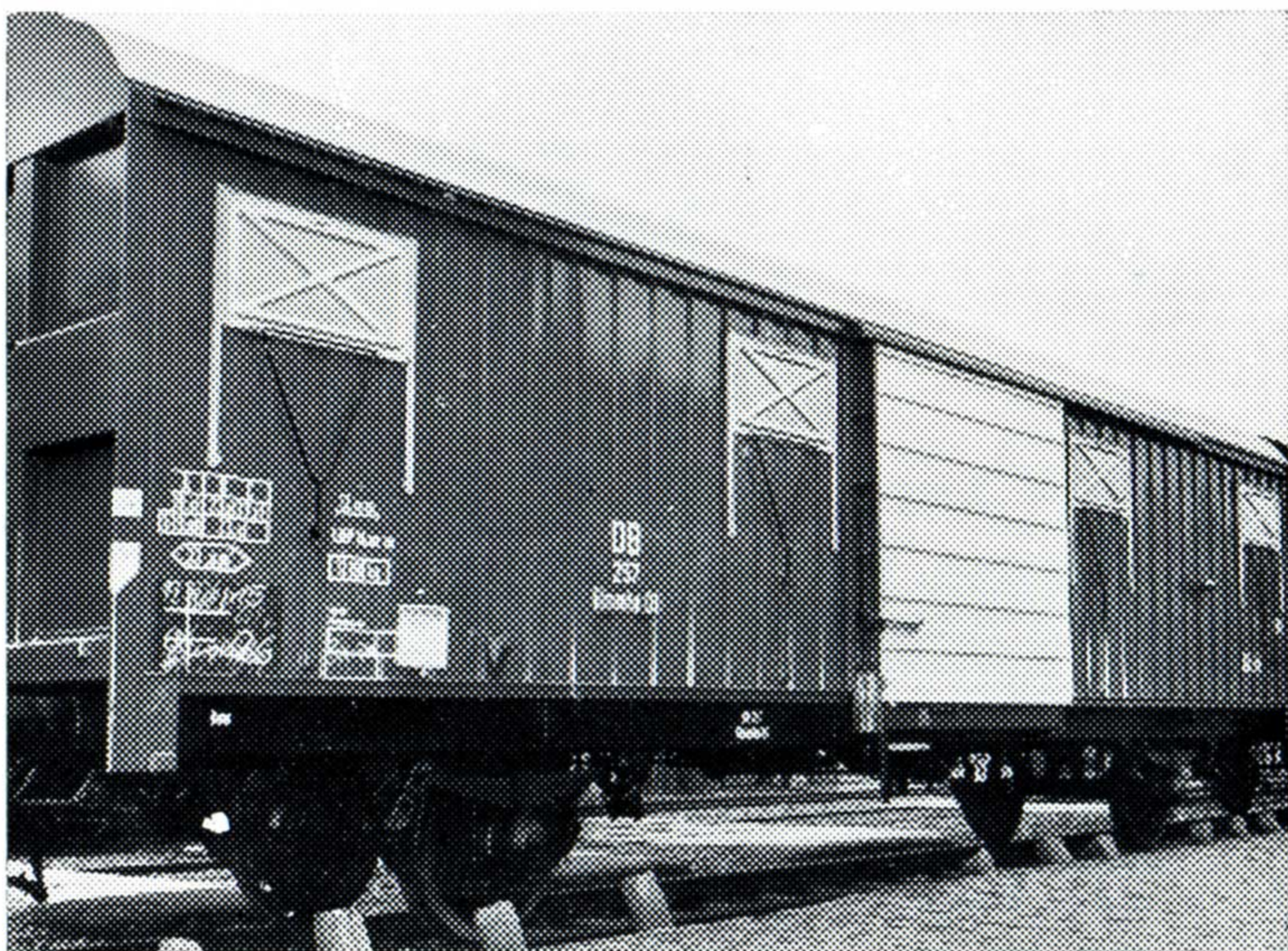
Photo 2. — Wagon couvert avec portes coulissantes en fibre de verre. (Document D.B.)
