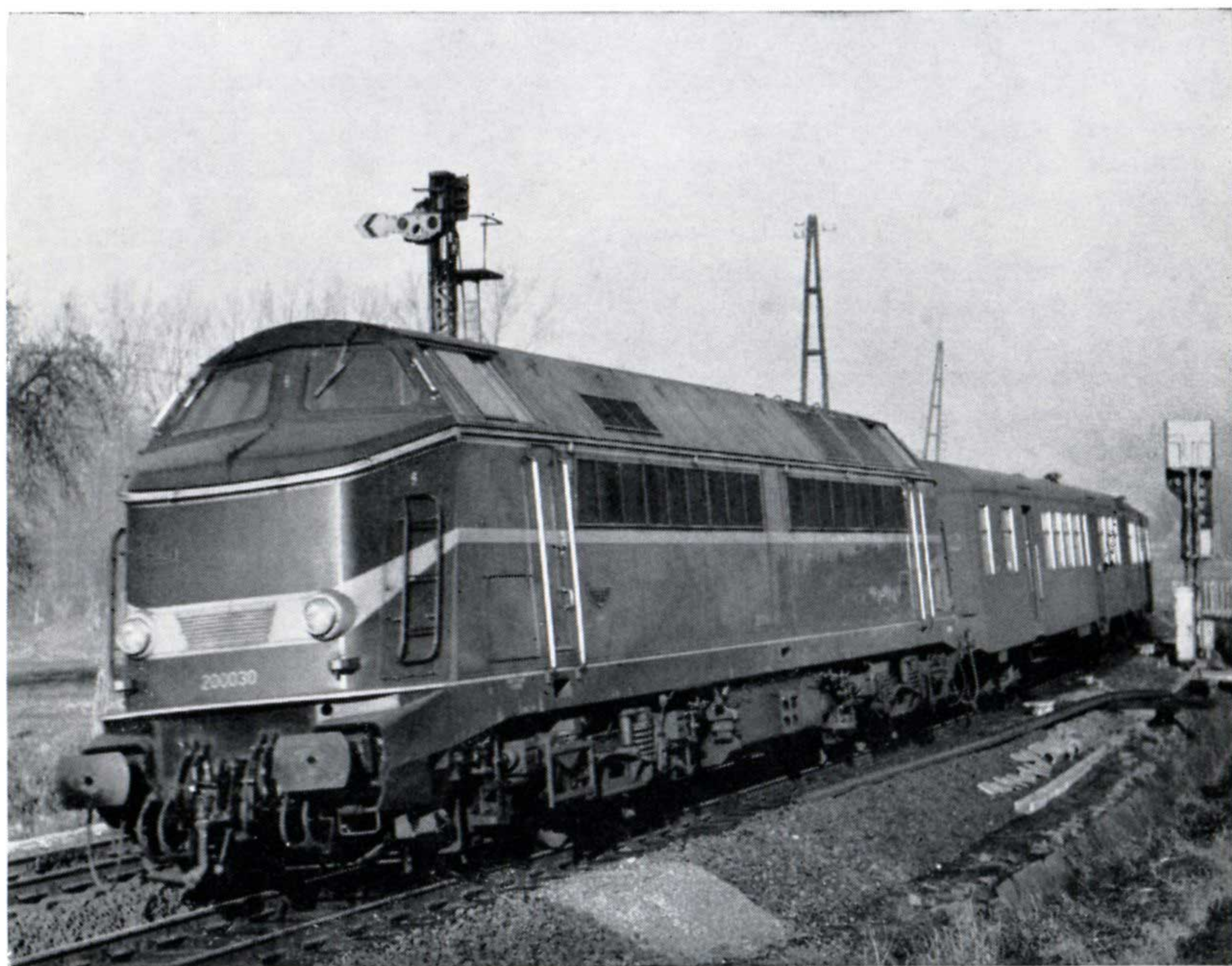
Locomotive C o -C o , Diesel-électrique de 2150 ch., type 200 de la S.N.C.B. ACEC a fourni l'équipement électrique de ces locomotives.
