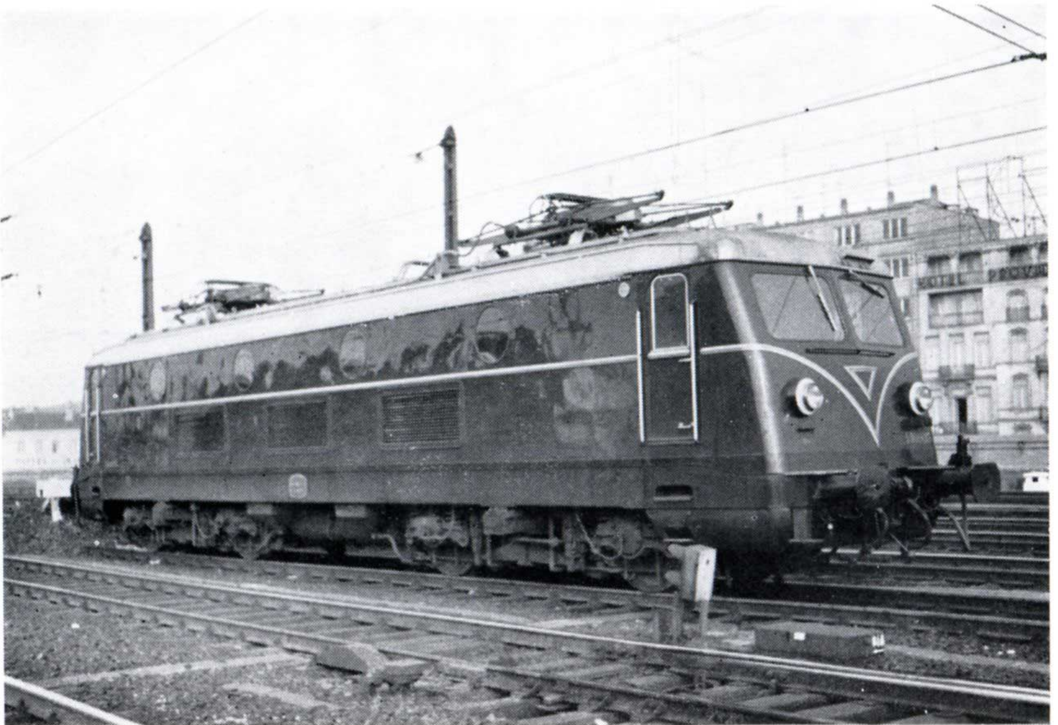
Fig. 5. — Locomotive BB type 140 de la S.N.C.B. Poids : 84 T Puissance unihoraire : 2.560 CV. (Photo B. Dedoncker)
