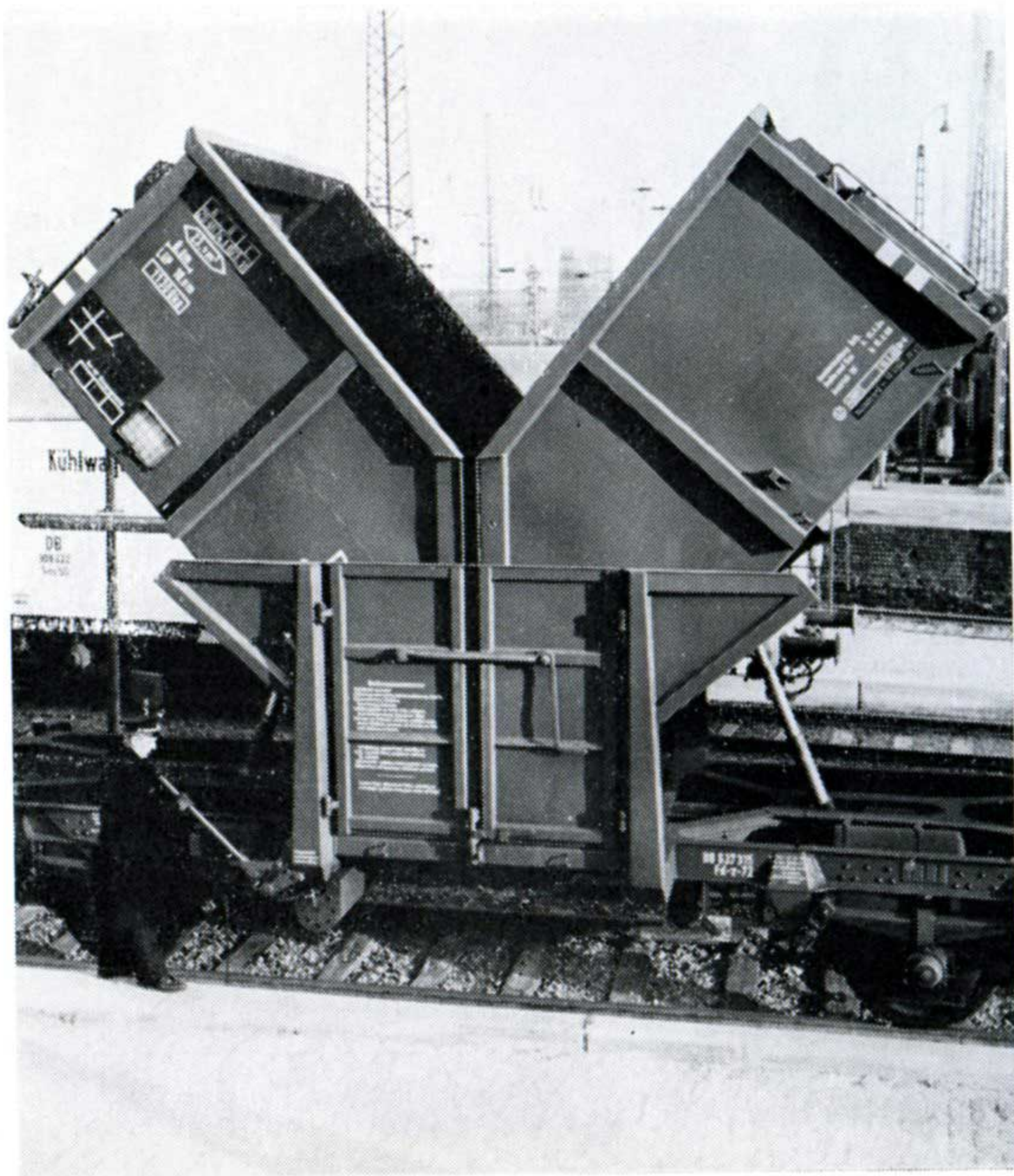
Wagon-tombereau D.B. de forme classique type Ommv mais à déchargement automatique.
