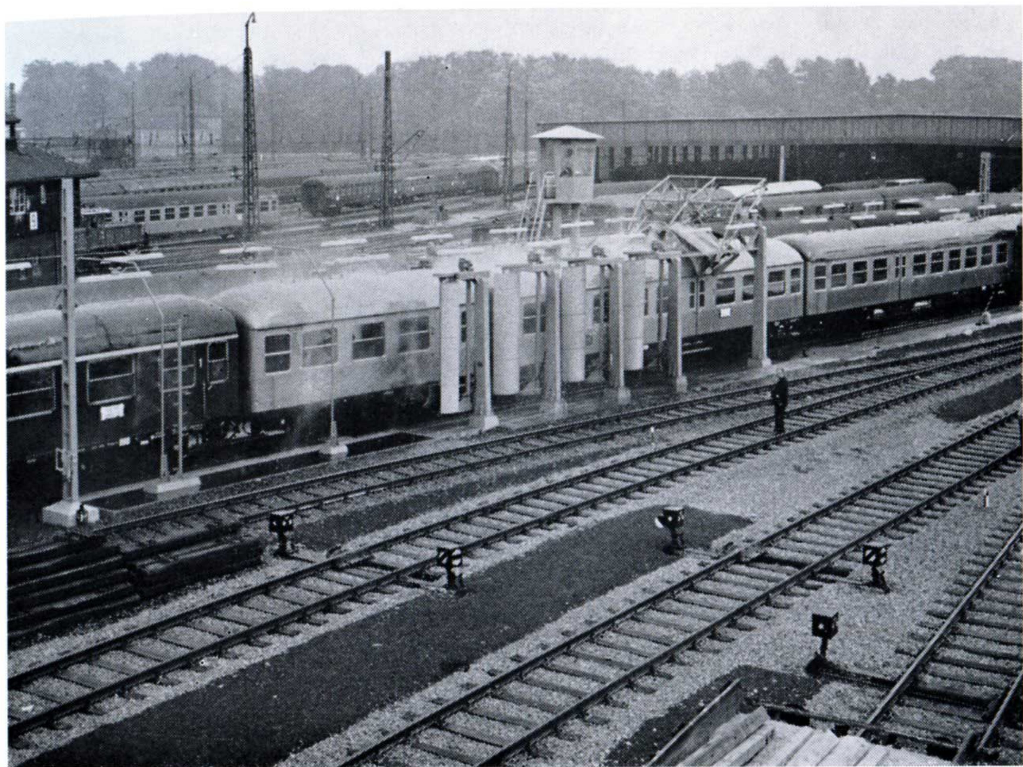
Autre chantier de lavage en continu à Stuttgart, à la cadence de 85 m. en 5 minutes
