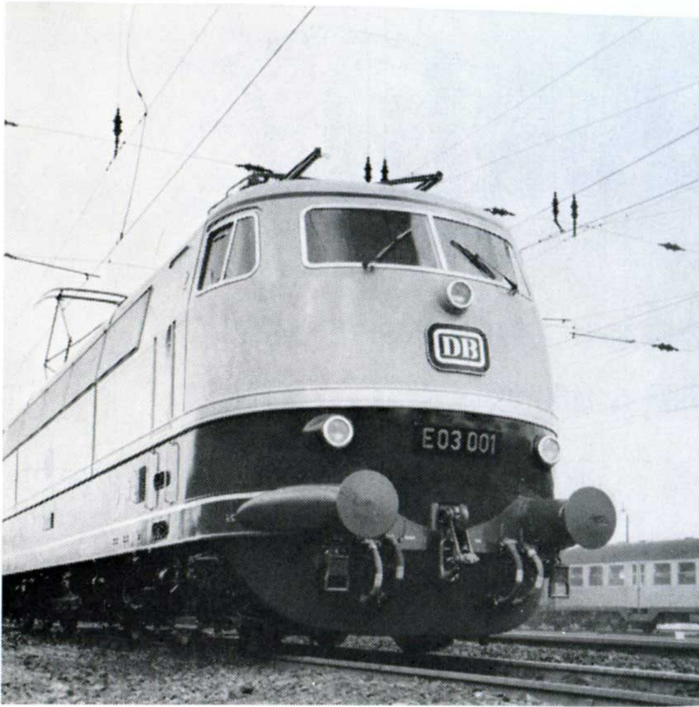
La locomotive CC série E 03 de la D.B. a été conçue pour remorquer les grands express à 200 km/h.
