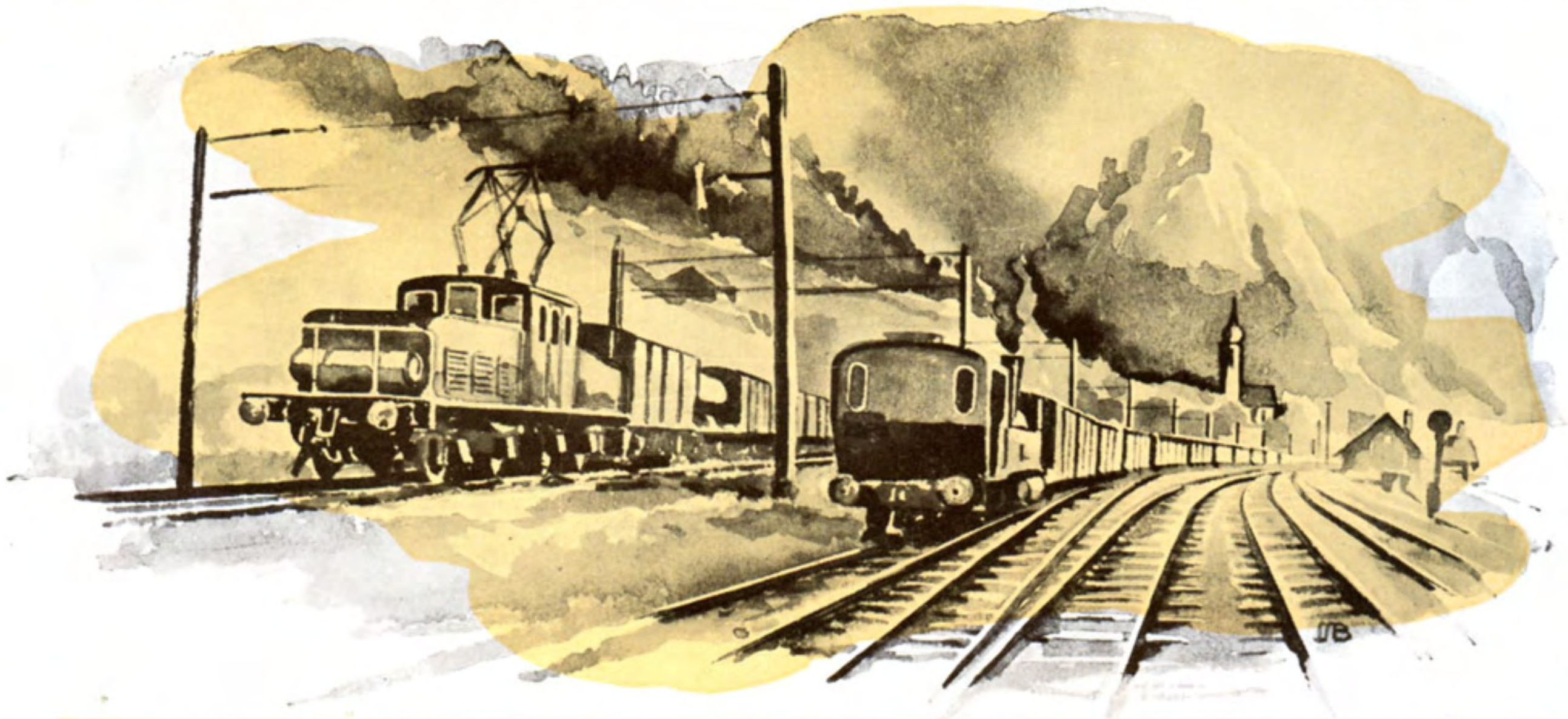
Locomotive de manœuvre, poids à vide 36 tonnes. Effort au crochet 8500 kg pour f = 0,60 .
