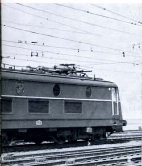
Fig. 1. - La locomotive type 123 de la S.N.C.B. se distingue extérieurement de la locomotive type 122, par le double V sur l'avant et par la présence d'ouies de ventilation sur les longs pans.
