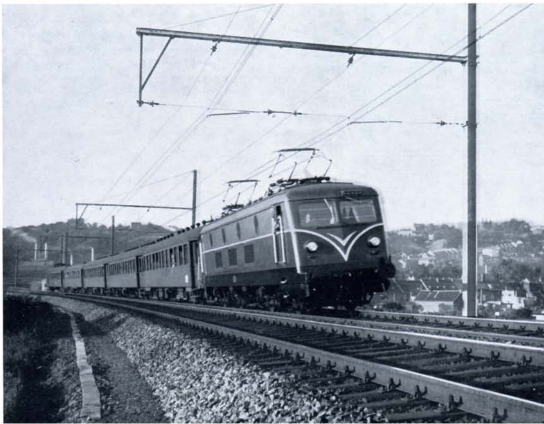
Fig. 7. - Locomotive type 123 remorquant un train de voyageurs sur la rampe de Dave (16 ‰) à la sortie de Namur.
