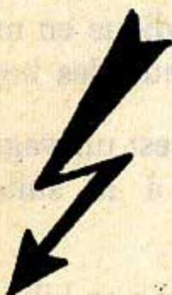
A proximité des marchepieds et échelles et aux angles du wagon = signe «Attention» sur les véhicules munis de marchepieds, échelles ou passerelles situés à plus de 2 m du niveau du rail et wagons munis de la canalisation de chauffage.
