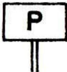
Poteau surmonté d'un petit panneau portant la lettre « P ». Il s'adresse à des mouvements de garage par rebroussement ou à des mouvements de ~~manœuvre~~ <sup>feux</sup> enclenchés comportant une opération de rebroussement non commandée par un signal fixe.
